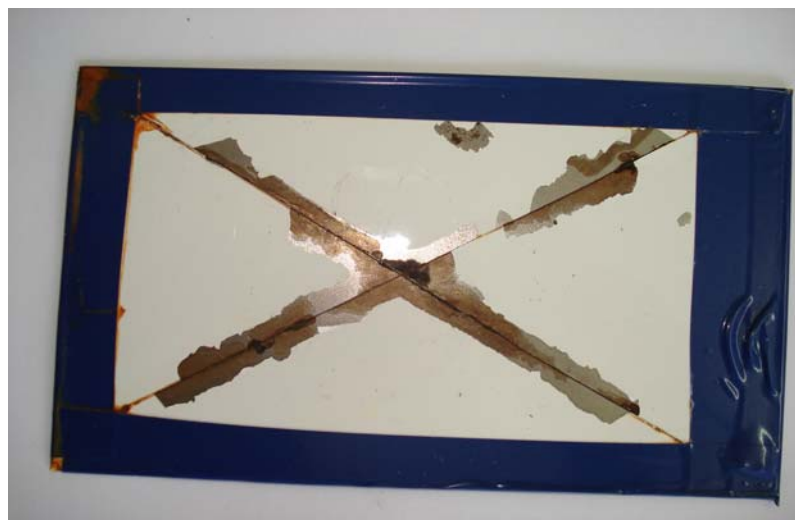
Figura 28 - Resultado de teste de salt spray aço laminado a frio tratado com \text{Al}_2\text{O}_3/\text{ZrO}_2 .
