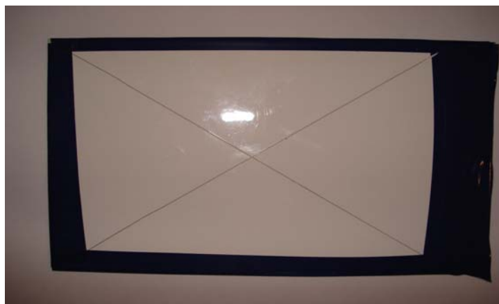
Figura 30 - Resultado de teste de salt spray alumínio tratado com \text{Al}_2\text{O}_3/\text{ZrO}_2 .
