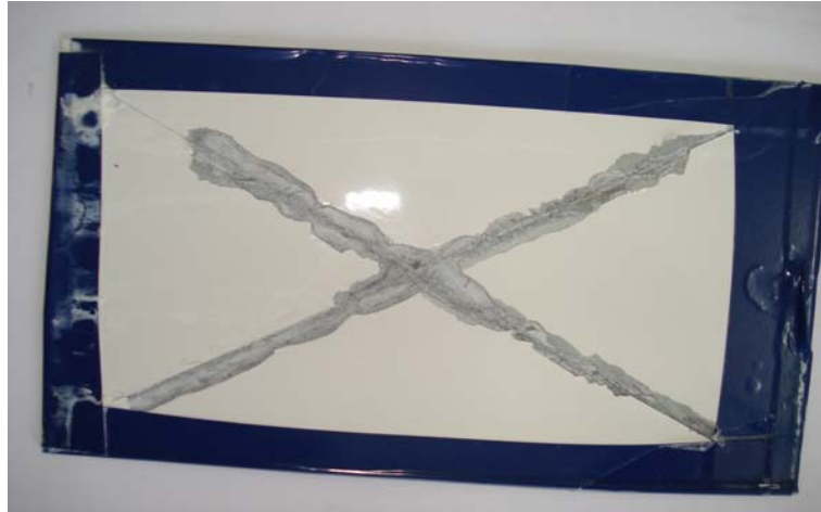
Figura 29 - Resultado de teste de salt spray aço galvanizado minimizado tratado com \text{Al}_2\text{O}_3/\text{ZrO}_2 .
