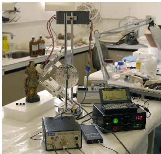
Figura 14- Sistema portátil de EDXRF posicionado para a medida do pigmento de uma das regiões da escultura de Santa Luzia.
