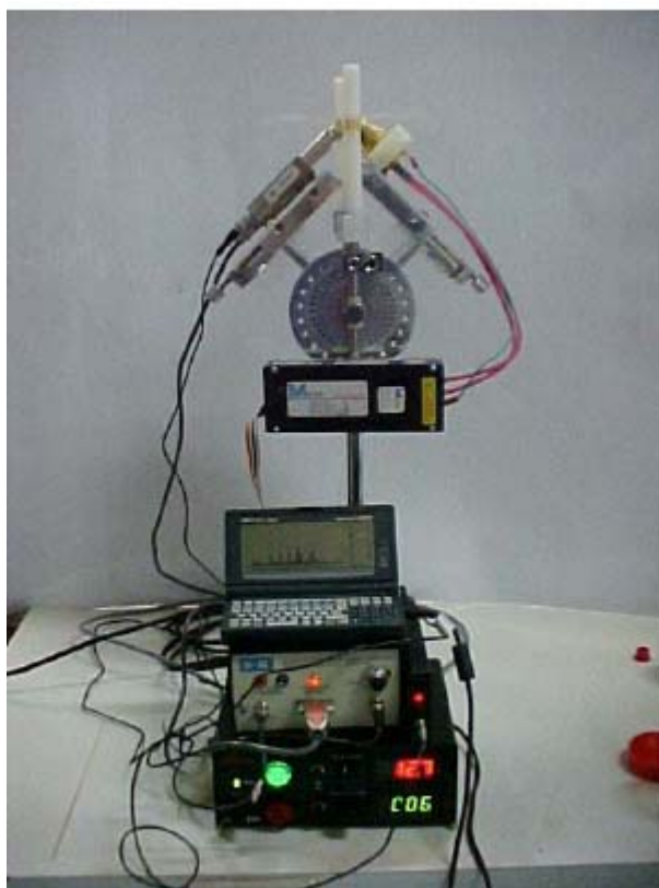
Figura 13- Equipamento portátil de EDXRF. No topo da figura, o detector está à esquerda e o tubo de raios X à direita.
