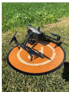
Figura 20 – Equipamento VANT DJI Inspire 2 utilizado para realização dos voos.
