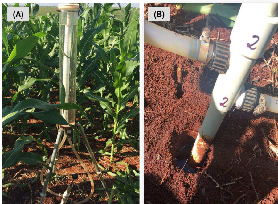
Figura 2. Permeômetro de Guelph (A); poço de infiltração construído para obtenção das leituras de fluxo (B).
