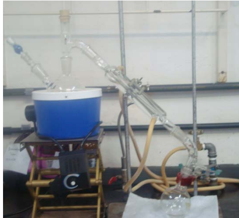
Figura 10 - Equipamento utilizado para a destilação dos produtos de desidratação da glicerina
