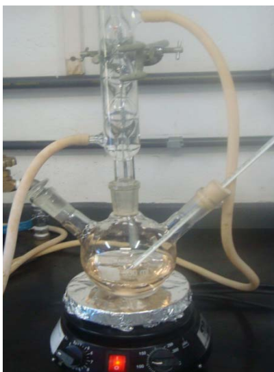
Figura 9 - Equipamento utilizado para a desidratação da glicerina.
