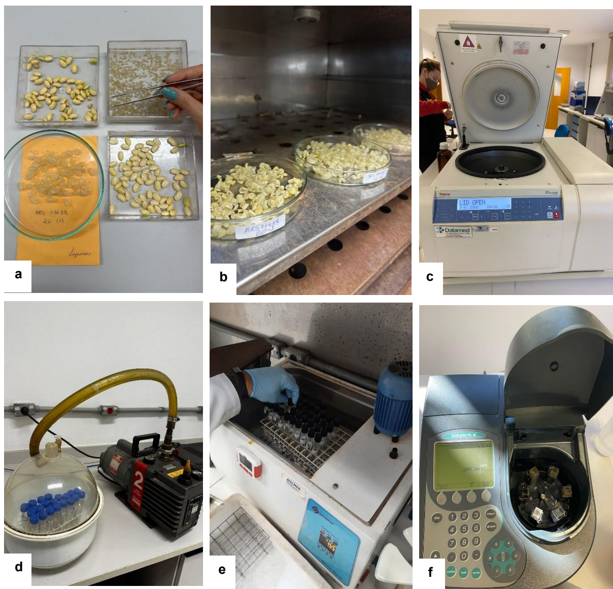
Figura 5. Remoção do tegumento das sementes de soja (a); Dessecação em estufa do tegumento (b); Centrifuga para homogeneização das amostras (c); Processo de floculação (d); Solubilização da lignina em banho maria (e); Leitura da absorbancia das amostras em espectrofotômetro UV com comprimento de onda de 280nm (f).
