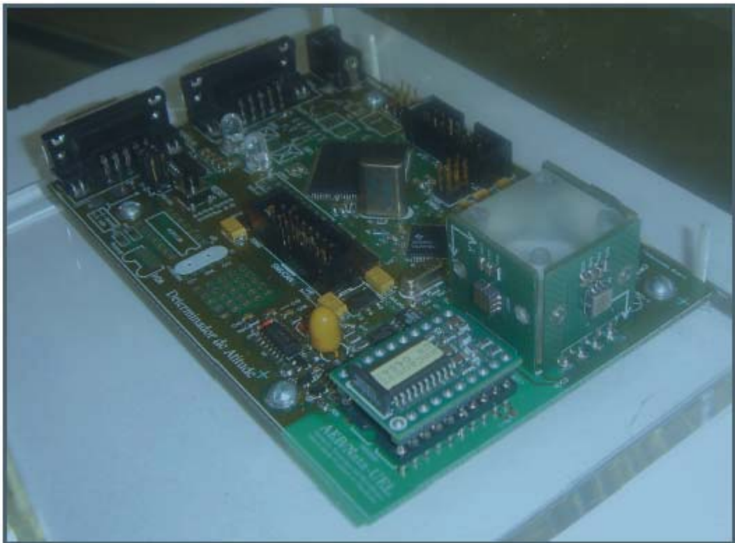
Figura 1.1 – Protótipo do determinador de atitude baseado em sensores MEMS
