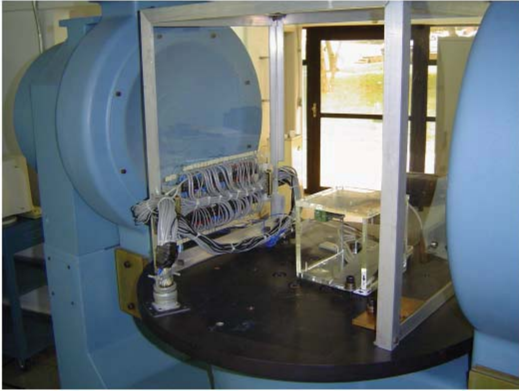
Figura 1.3 – Mesa de rotação. Protótipo de determinador de atitude no interior da mesa
