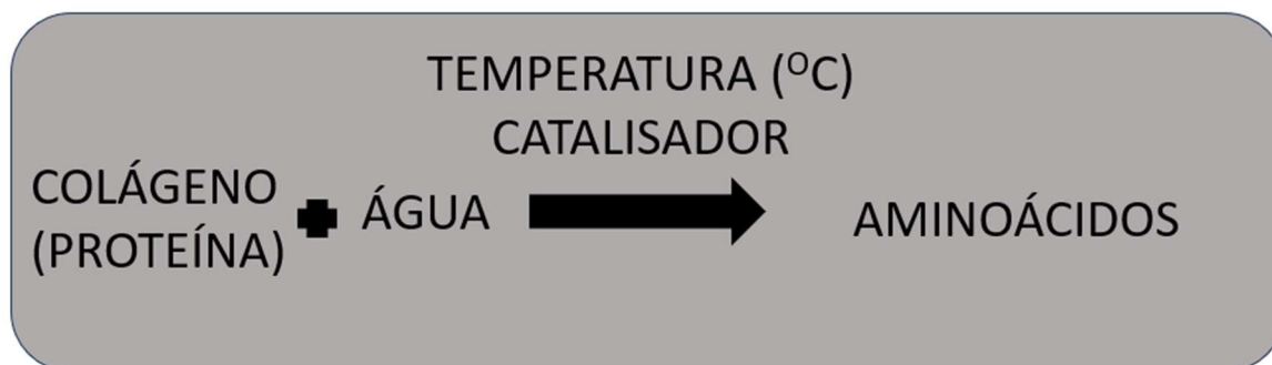
Figura 5: Esquema de Hidrólise de proteínas (Fonte: Próprio autor).
