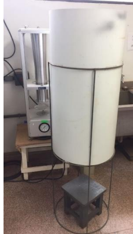
Figura 3.1 - Torre de Potter adaptada com estrutura de ferro cilíndrica (1,90 m de altura e 50 cm de diâmetro) revestida internamente por uma chapa de PVC, utilizada no bioensaio 4.
