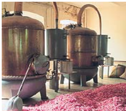
Figura 3 – Método de destilação a vapor. Fonte: CORAZZA (2002)
