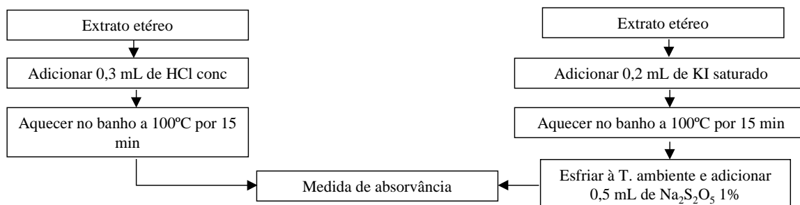
FIGURA IV.3: Fluxograma das reações colorimétricas (ALVES et al. , 2003a).
