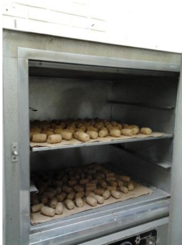
Figura III.4 Novos pellets de ração comercial para ratos Nuvilab® produzidos após a contaminação com 2,0 mg de Pb por Kg e secados na estufa a 60° C por 24 horas. Fonte: a autora.
