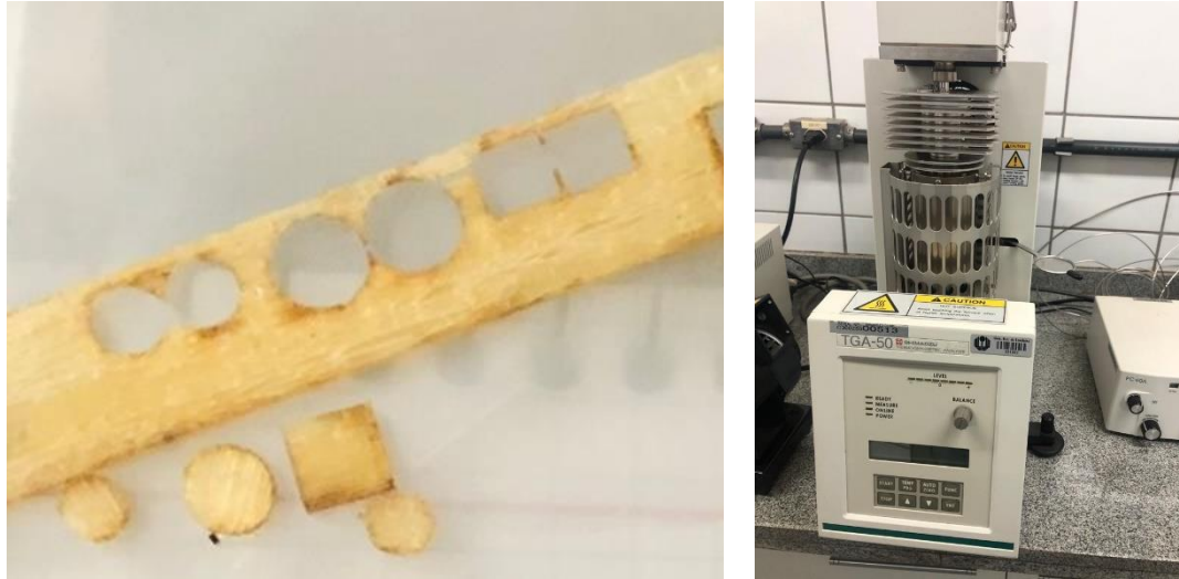
(a) Amostras cortadas a laser
