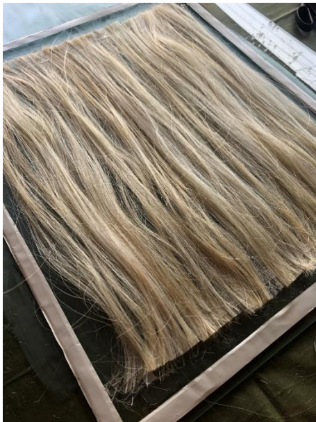
(c) Disposição da segunda camada de fibras e fixação da fita de vedação
