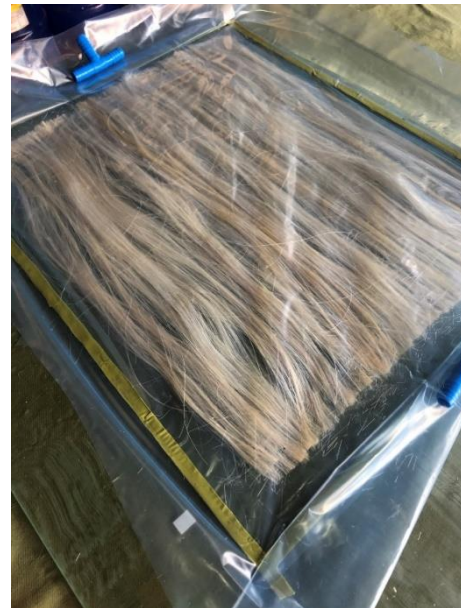
(d) Fechamento do sistema com a bolsa de vácuo e posicionamento das conexões T
