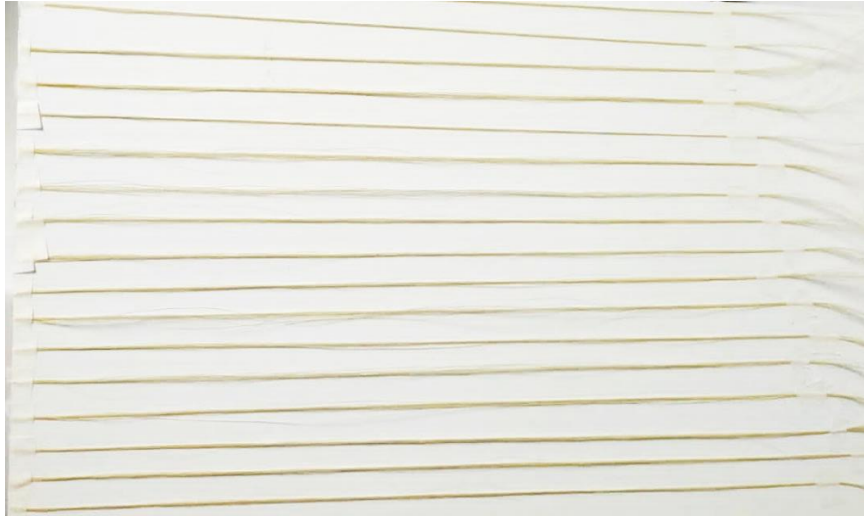
Figura 33 - Fibras de DT organizadas unidirecionalmente
