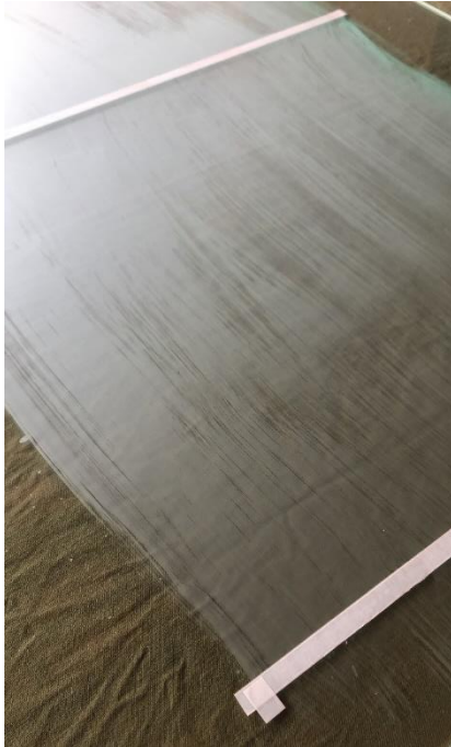
(a) Aplicação desmoldante
