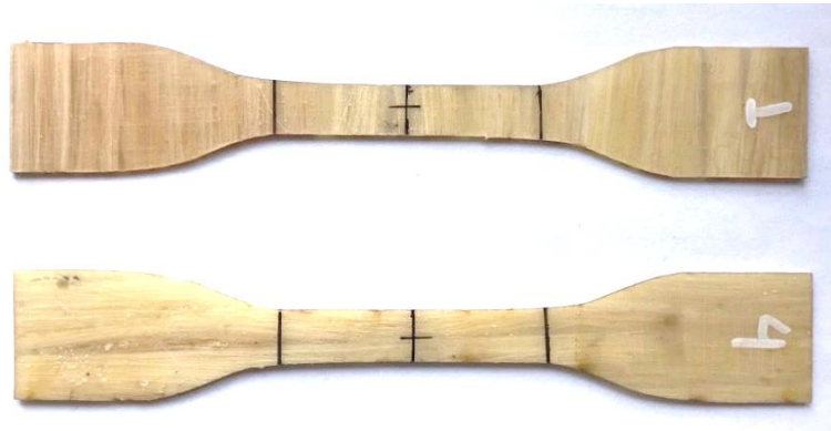
Figura 40 - Corpos de prova para ensaios de tração, fibras orientadas a 0° (CP 4) e a 90° (CP 1)
