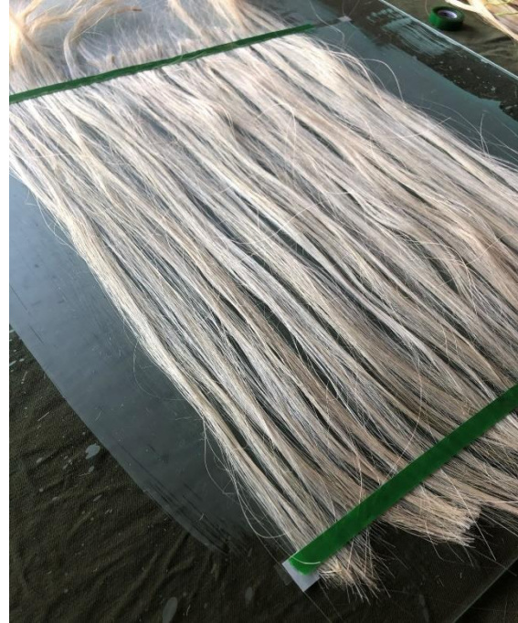
(b) Disposição da primeira camada de fibras e fixação com fita dupla-face
