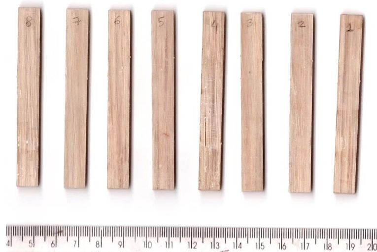
Figura 74 - Corpos de prova de compósitos DT/Epóxi 0^\circ antes da ruptura à flexão
