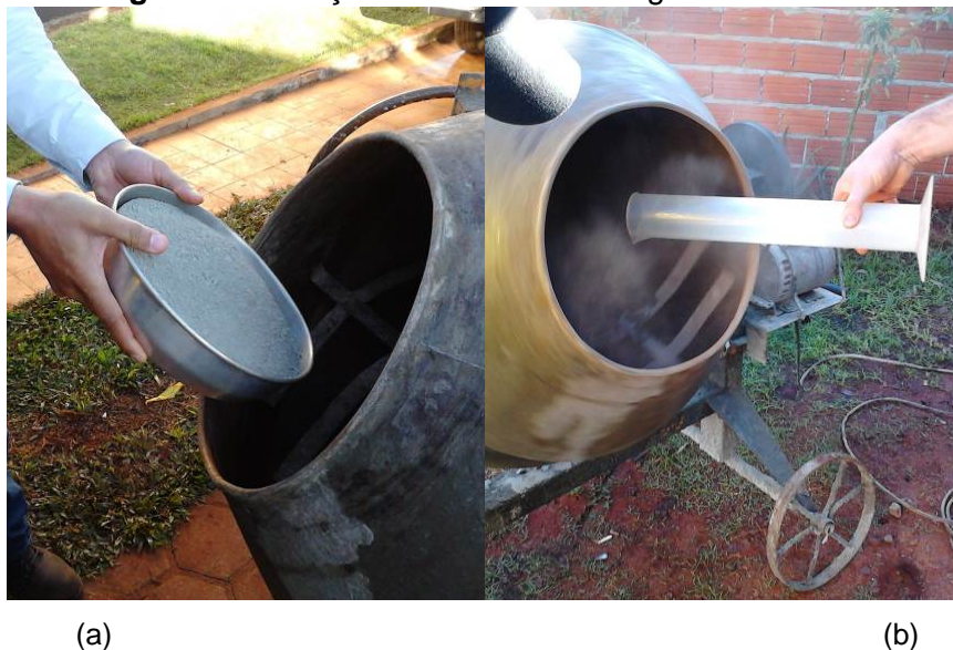
Figura 24 – Adição do cimento e da água na mistura.
