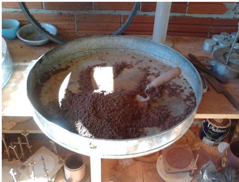
Figura 21 – Adição e mistura de cimento Portland ao solo.
