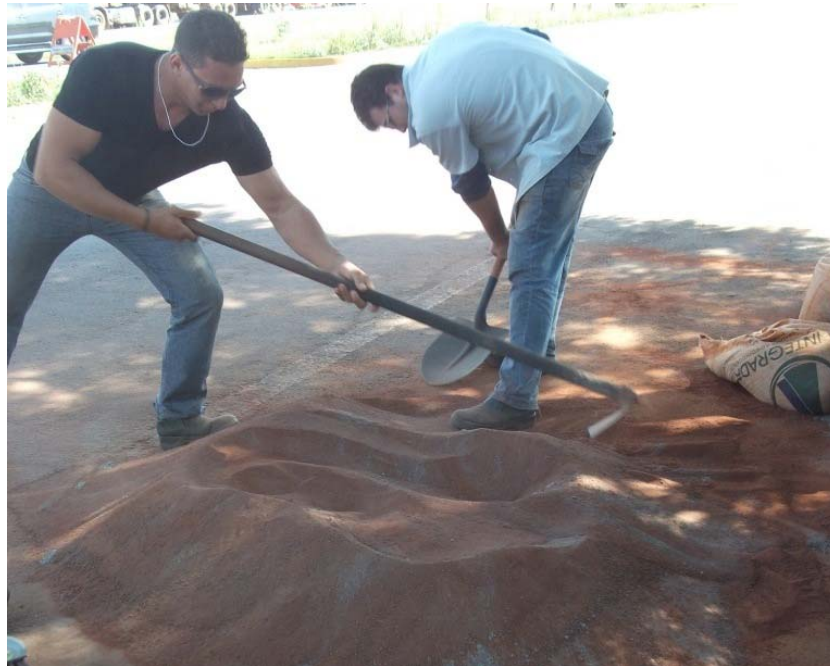
Figura 36 – Mistura manual dos materiais para o ensaio de campo.
