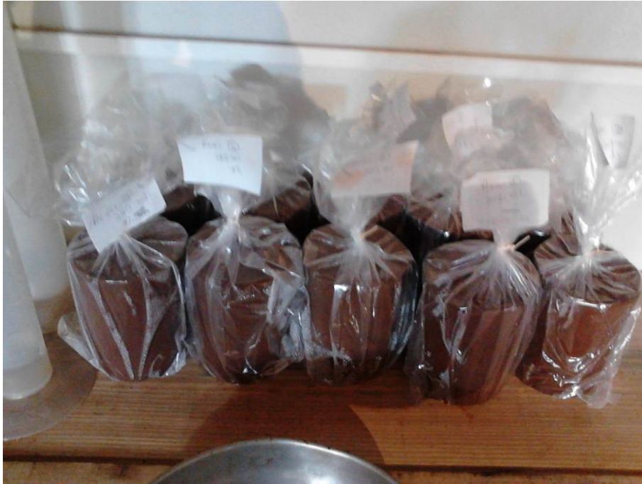
Figura 26 – Acondicionamento dos corpos de prova em sacos plásticos.
