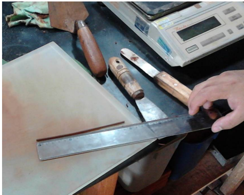
Figura 18 – Ensaio de Limite de Plasticidade.
