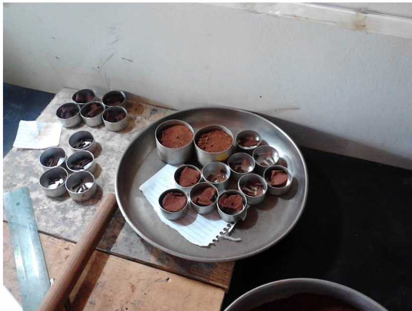
Figura 20 – Verificação do teor de umidade do solo.
