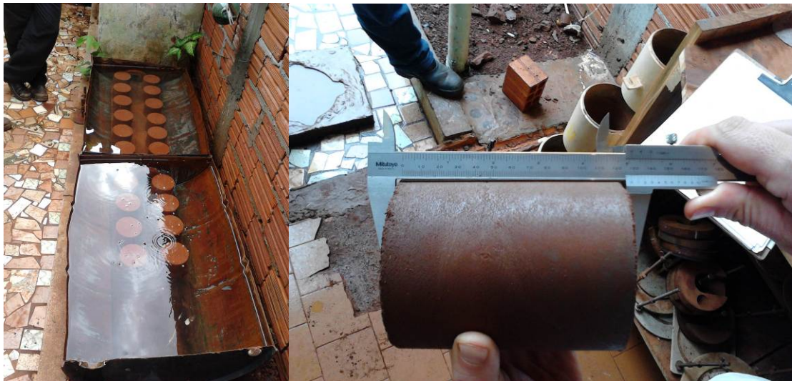
Figura 27 – Imersão e controle geométrico dos corpos de prova.
