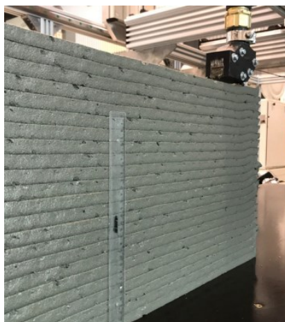
Figura 30 – Parede construída com camadas sobrepostas
