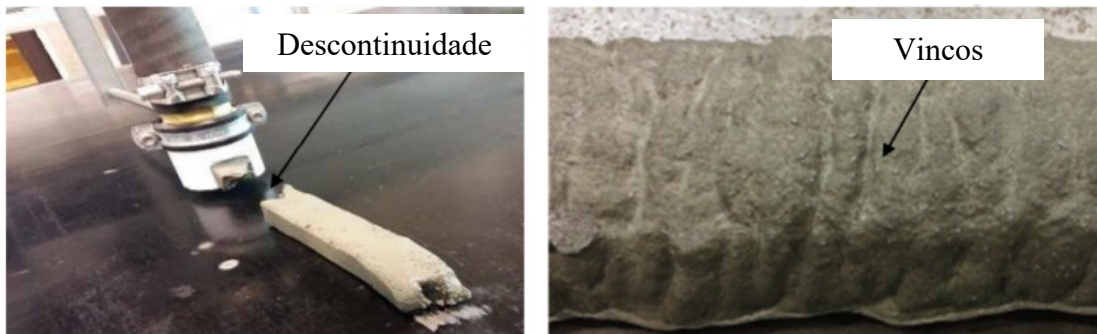
Figura 27 - Continuidade e coesão na extrudabilidade
