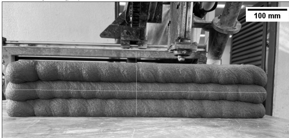
Figura 65 – Demarcação da reta na camada para cálculo da área
