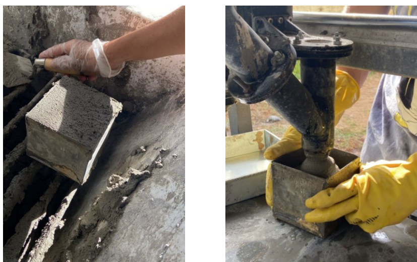
Figura 58. (a) Cubo com argamassa antes de ser extrudada. (b) Cubo sendo preenchido de argamassa após ter sido extrudada.
