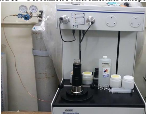
Figura 53 – Porosímetro Micromeritics Autopore IV
