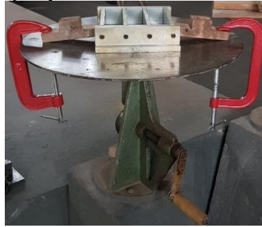
Figura 58 – Adaptação de fixação para o adensamento dos corpos de prova prismáticos
