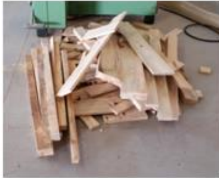
Figura 38 - Parte das madeiras desclassificadas durante processo de usinagem
