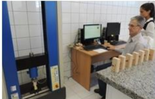
Figura 68 - Máquina Universal de ensaios DL 10000 e célula de carga 100 kN – Laboratório SENAI em Arapongas / PR
