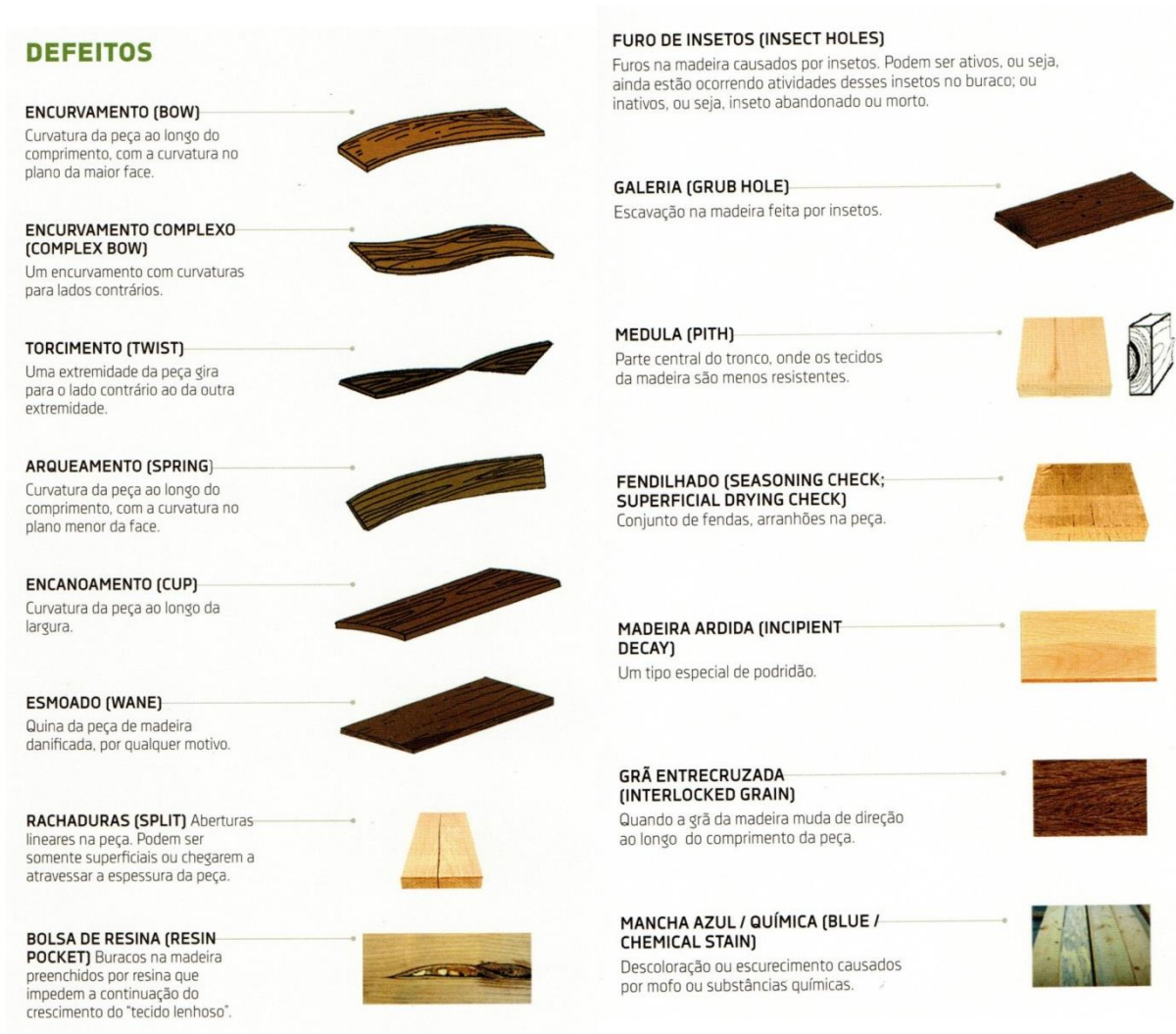
Figura 5 - Manual para classificação da madeira – defeitos
