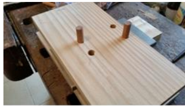
Figura 61 - Montagem do corpo de prova normal às fibras, com cavilhas de madeira, inserindo estas através dos dois lados e com uso dos separadores.
