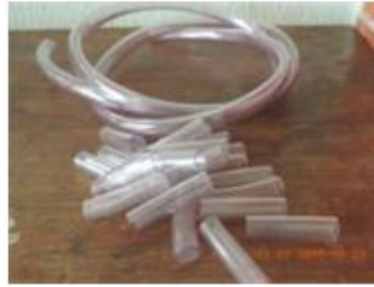
Figura 57 - Característica inicial da mangueira, gerando peças levemente curvas.
