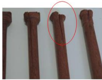
Figura 30 - Peças torneadas para conformação das cavilhas apresentando fedilhamento.
