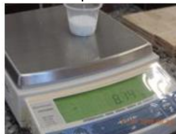
Figura 49 - Pesagem dos componentes em balança de precisão
