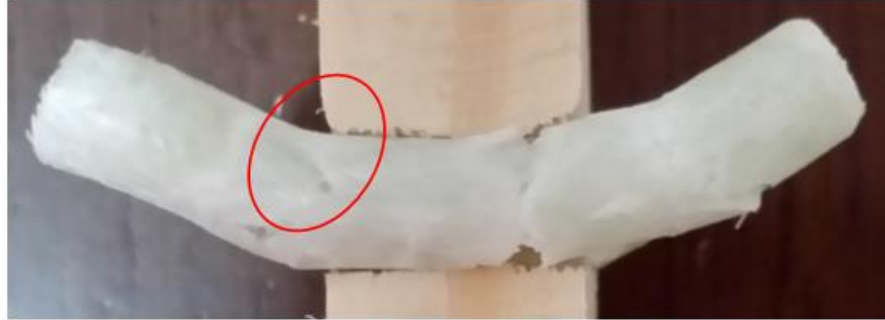
Figura 77 - Demonstração em vista longitudinal da cavilha de compósito e seus locais de ruptura, quando sujeita à aplicação de uma determinada carga.
