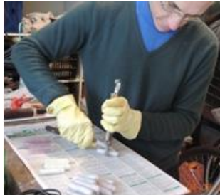
Figura 53 - Processo de retirar as cavilhas de compósito das matrizes
