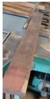
Figura 26 - Madeira de Jatobá utilizada para confeccionar cavilhas para ensaio da fase 1
