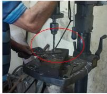
Figura 32 - Retifica da matriz para extrusão das cavilhas de madeira
