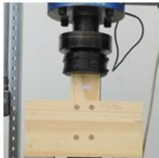
Figura 71 - Corpo de prova com cavilha de madeira – normal às fibras
