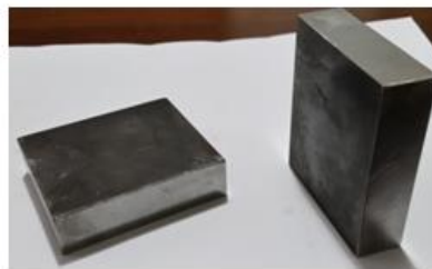
Figura 66 - Bases metálicas elaboradas para dar sustentação ao corpo de prova
