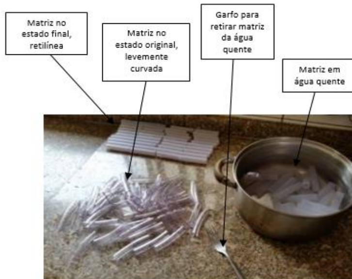
Figura 58 - Processo de tornar matrizes retas
