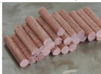
Figura 27 - Cavilhas de Jatobá para ensaio da fase 1
