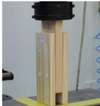
Figura 72 - Corpo de prova com cavilha de compósito – paralelo às fibras
