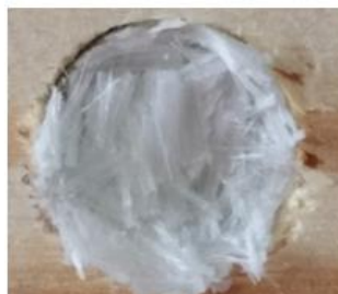
Figura 79 - Representação da secção transversal da ruptura da cavilha de compósito
