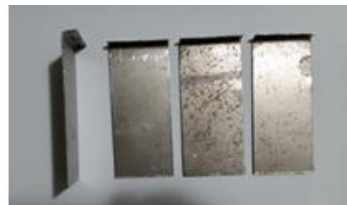
Figura 60 - Espaçadores de aço para evitar o engrenamento entre as peças
