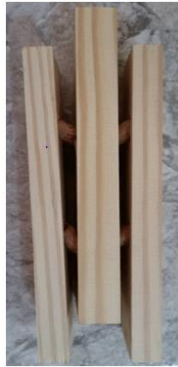
Figura 74 - Corpo de prova paralelo às fibras com cavilhas de madeira
