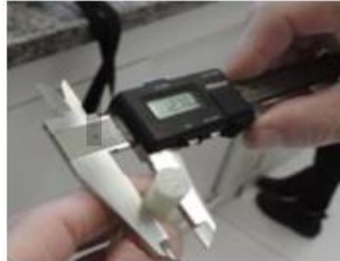
Figura 55 - Conferencia das dimensões das cavilhas após a cura
