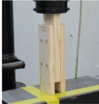
Figura 73 - Corpo de prova com cavilha de madeira – paralelo às fibras
