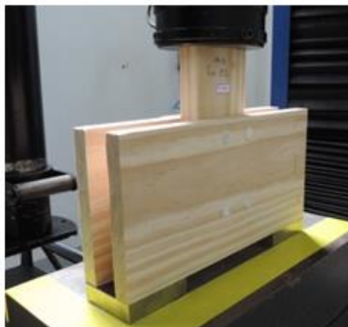
Figura 24 - Ensaio de fase 2 - Normal às fibras, com cavilhas de madeira e de compósito
