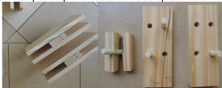
Figura 63 - Corpos de prova descartados ao apresentarem defeitos.
