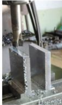
Figura 64 - Usinagem do aparelho de carregamento utilizado na fase 1 de ensaios
