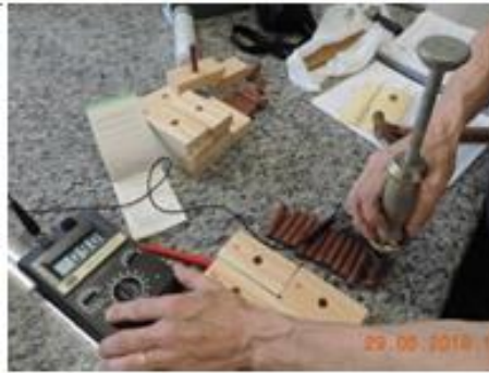
Figura 44 - Aparelho para medir percentual de umidade das madeiras utilizadas, nas diversas etapas da pesquisa.
