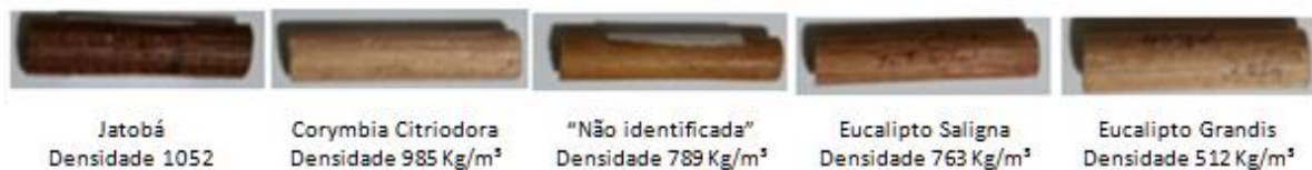
Figura 28 - Tipos diferentes de madeira testados para elaboração das cavilhas da fase 2
