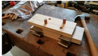
Figura 62 - Montagem do corpo de prova paralelo às fibras, com cavilhas de madeira, inserindo estas através dos dois lados e com uso dos separadores.
