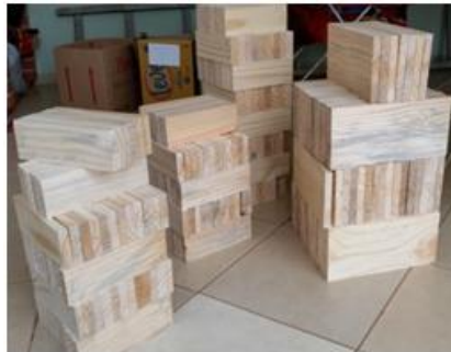
Figura 39 - Madeiras desclassificadas durante processo por ultrassom e visual
