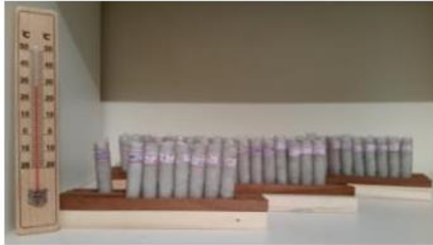
Figura 52 - Ciclo de cura das cavilhas de compósito
