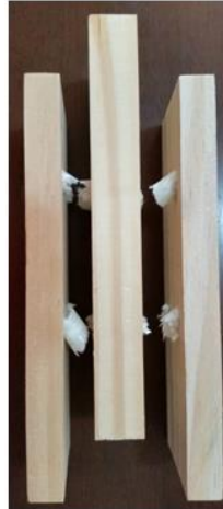
Figura 75 - Corpo de prova paralelo às fibras com cavilhas de compósito
