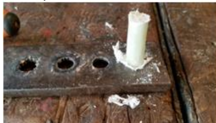
Figura 56 - Simulação do processo de retífica das cavilhas de compósito
