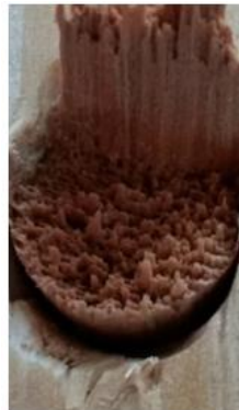
Figura 78 - Secção de rompimento da cavilha de madeira
