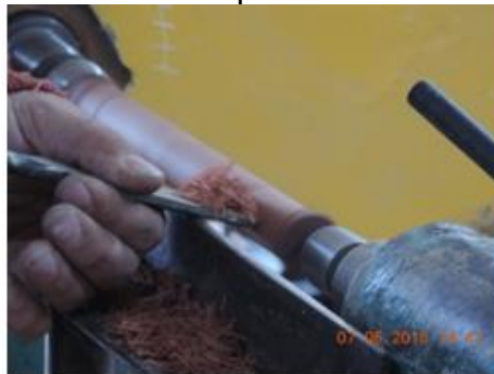
Figura 29 - Técnica de tornear para obter as cavilhas de madeira
