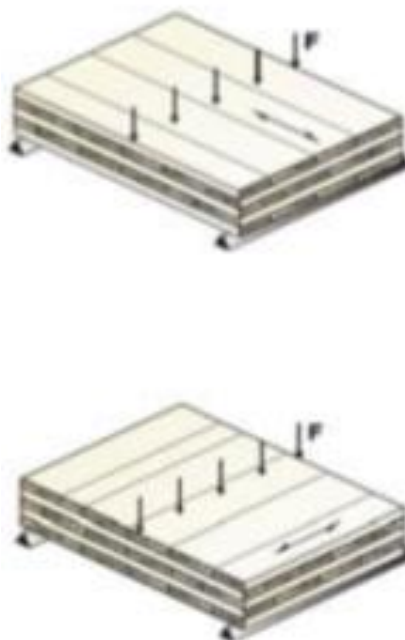
Figura 24. Aplicação de força para teste de flexão no sentido longitudinal e transversal ao eixo. Fonte: FPIinnovations (2011) CLT Handbook .
