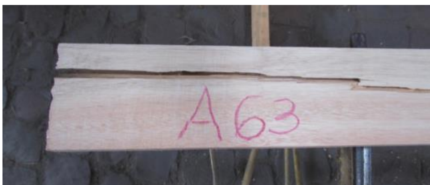
Figura 29. Rachadura da peça de medula de eucalipto. Fonte: Autor.
