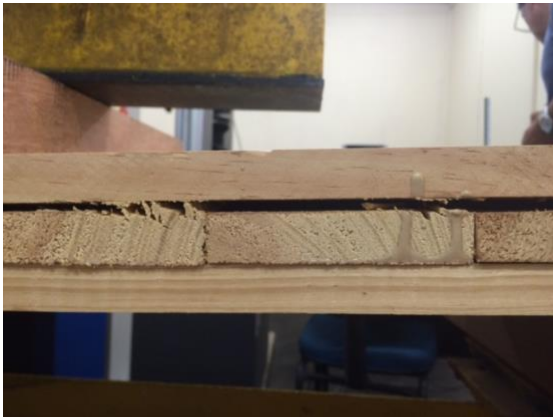
Figura 61. Painel do PPP do grupo 1, detalhe da falha na linha de cola. Fonte: autor.
