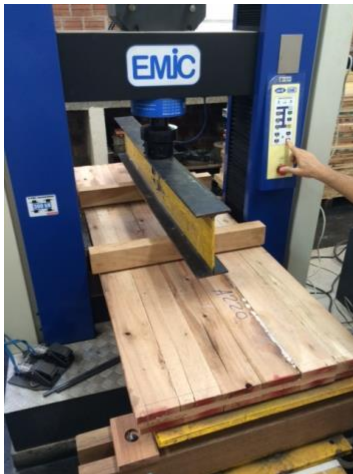
Figura 46. Painel CLT no equipamento para teste de flexão e ruptura. Fonte: autor.
