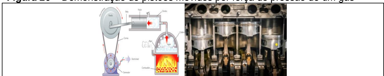
Figura 26 – Demonstração de pistões movidos por força de pressão de um gás
