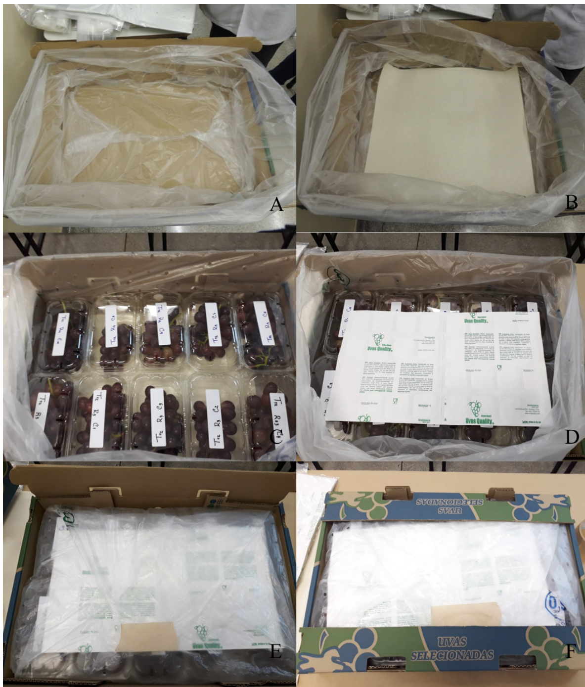
Figura. 3.1.5. Etapas de embalagem das uvas. A: Acomodação do bolsão plástico perfurado na caixa de papelão corrugado; B: Disposição da folha de papel absorvente de umidade; C: Arranjo das uvas embaladas em cumbucas plásticas na caixa; D: Acomodação da folha geradora de \text{SO}_2 sobre as cumbucas; E: Fechamento e lacre do bolsão plástico perfurado; F: Fechamento da caixa para o armazenamento em câmara refrigerada. Fonte: O próprio autor.
