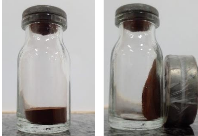
Figura 19. \text{Fe}_3\text{O}_4/\text{SiO}_2/\text{MIP} sem e com aproximação de um campo magnético externo, respectivamente
