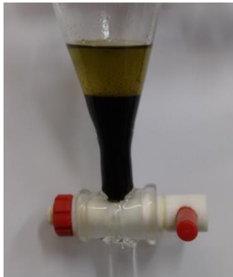
Figura 18- Separação dos ésteres metílicos
