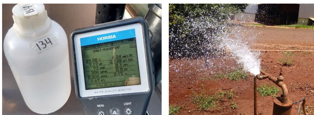
Figura 5 Atual amostra P33 e leitor de multiparâmetros Horiba-U52 (esquerda). Hidrômetro do atual ponto P45 (direita).
