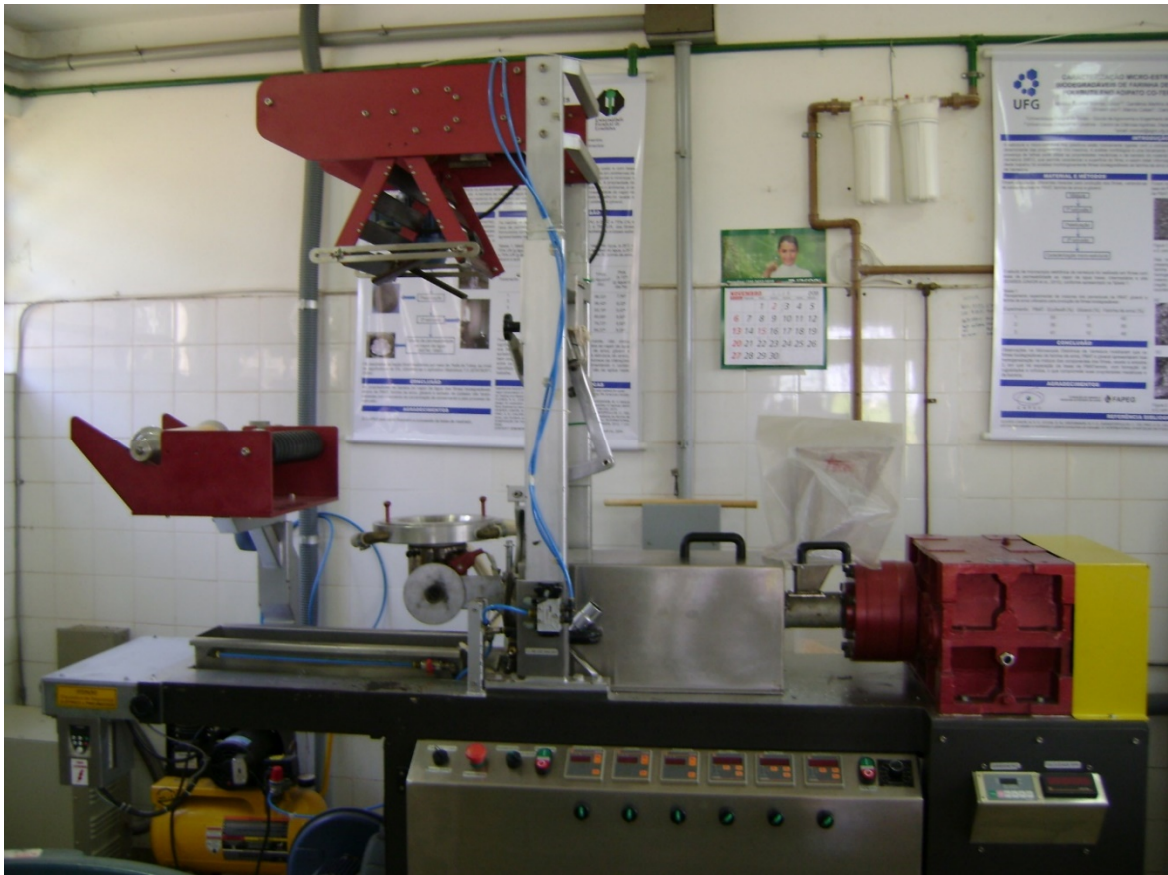
Figura 13. Extrusora monorrosca com os periféricos para a extrusão por sopro em balão ou para a produção de perfis cilíndricos. (Fonte: o autor).
