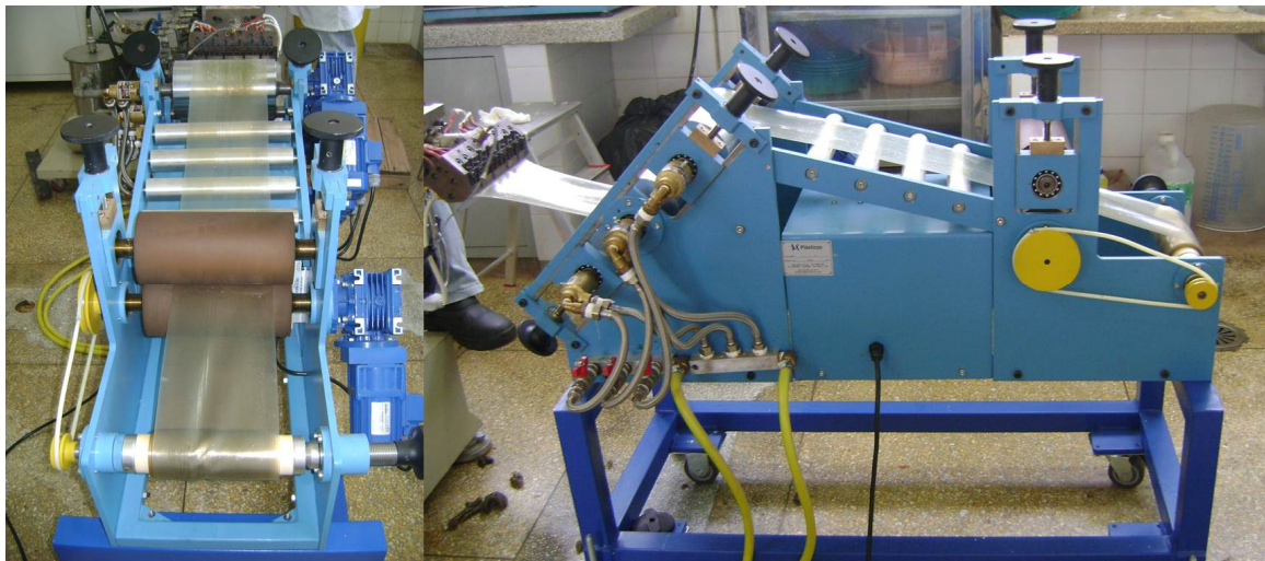
Figura 7. Funcionamento da extrusora duplarrosca acoplada com a calandra para a produção de laminados biodegradáveis (Fonte: Zanela, 2013).
