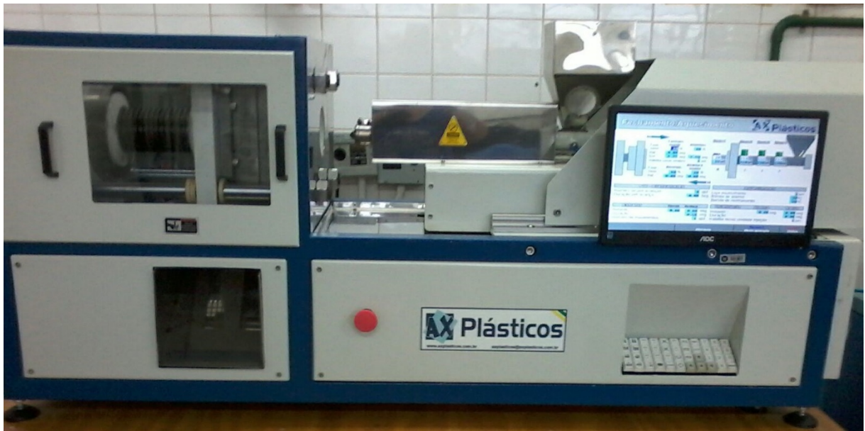
Figura 15. Injetora em escala piloto de termoplásticos utilizada no desenvolvimento do trabalho (Fonte: o autor).
