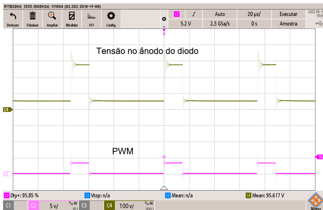
Figura 49 – Forma de onda da tensão sobre o ânodo do diodo do protótipo.
