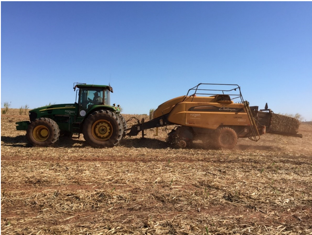
Figura 10 – Enfardadora da palhada da cana-de-açúcar em operação
