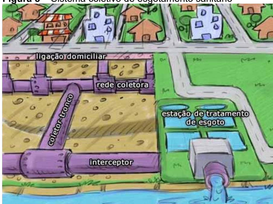
Figura 8 – Sistema coletivo de esgotamento sanitário
