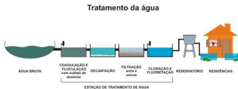
Figura 7 – ciclo do tratamento de água
