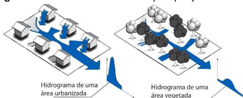
Figura 4 – Escoamento e vazão da precipitação
