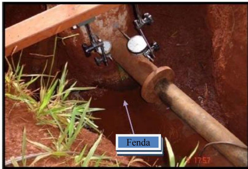
Figura 5.2 – Estaca S2 solicitada com pré-inundação do solo
