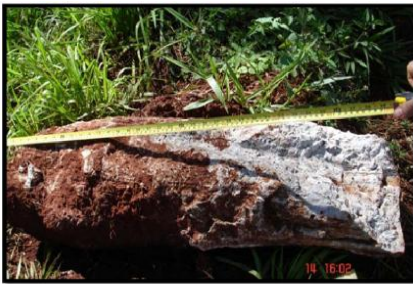
Figura 5.6 – Extremidade superior da estaca S3 extraída
