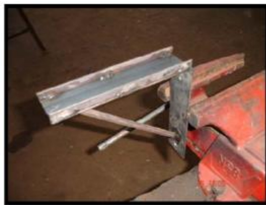
Figura 4.5 – Suporte metálico utilizado nos ensaios
