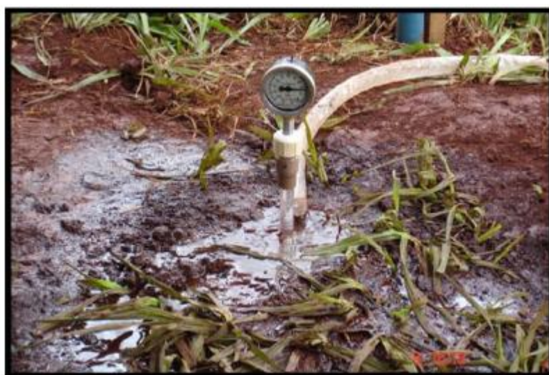
Figura 5.11 – Processo de umedecimento do solo e tensiômetros
