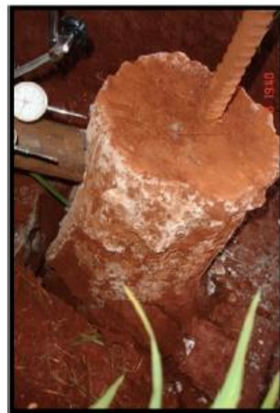
Figura 5.5 – Deslocamento do solo durante prova de carga da estaca S3
