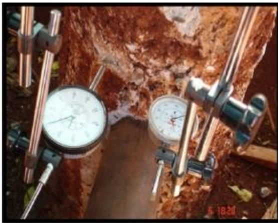
Figura 4.13 – Detalhe dos extensômetros
