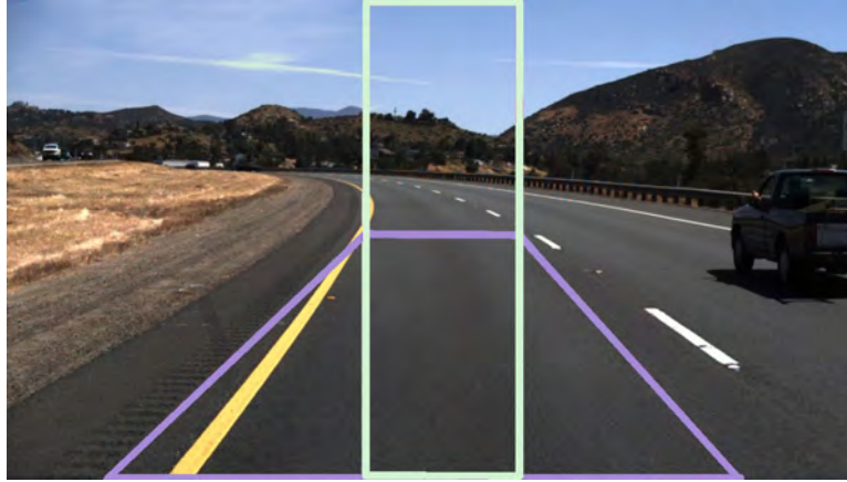
Figura 2.11: Em roxo o plano do solo fixo e em verde o plano desejado da transformação IPM.
