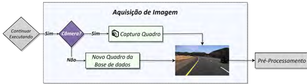
Figura 4.5: Diagrama simplificado do processo de aquisição de imagem no sistema embarcado.
