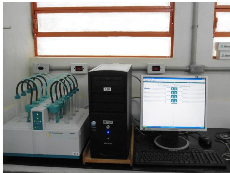
Figura 2 - Equipamento Rancimat (METHROM).
