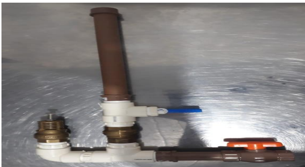
Carneiro hidráulico em válvulas metálicas.
