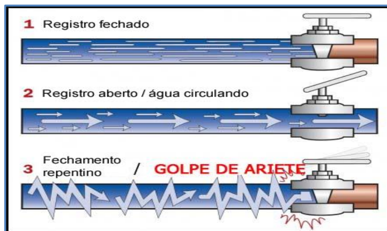
Figura 6: Ilustração da formação do fenômeno golpe de aríete ( https://pt.linkedin.com/pulse/voc%C3%AA-sabe-o-que-%C3%A9-golpe-de-ariete-e-consequ%C3%Aancias-por-instruflow )
