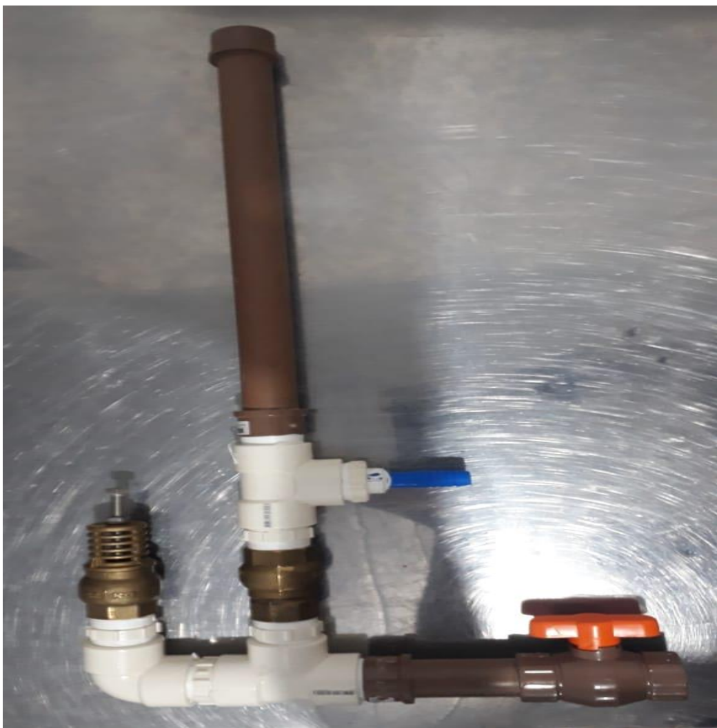
Figura 5: Carneiro hidráulico em válvulas metálicas produzido pelo autor.
