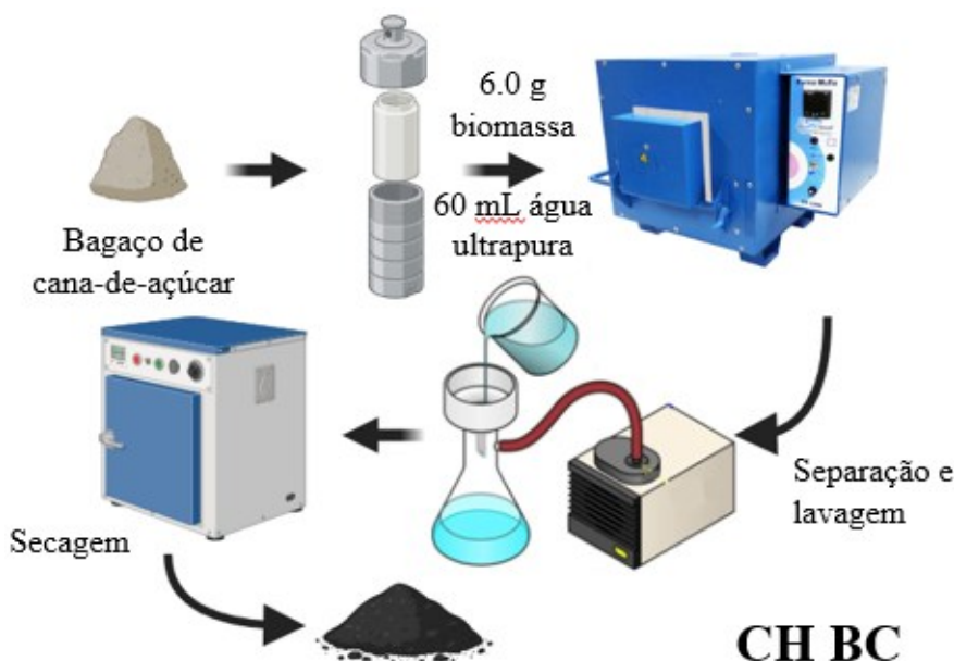
Figura 7 – Representação esquemática da preparação do biocarvão (CHBC) por carbonização hidrotérmica de bagaço de cana-de-açúcar a 215 \pm 15 °C por 12 h.
