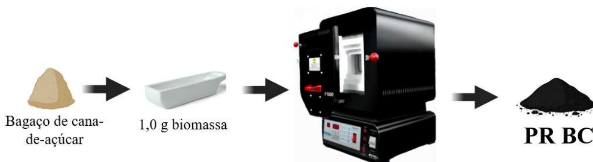
Figura 9 - Representação esquemática da preparação do biocarvão (PR BC) por pirólise do bagaço de cana-de-açúcar a 400, 700, 1000 e 1300 °C por 1,0 h.
