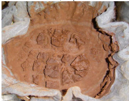
Figura 32 – Torta de lodo tipo A após 5 dias de secagem na condição controlada de verão (ST 35,6%)
