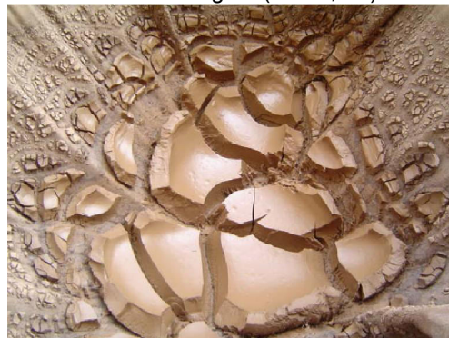
Figura 41 - Torta de lodo do lodo tipo B após 7 dias de secagem (ST 30,2%)
