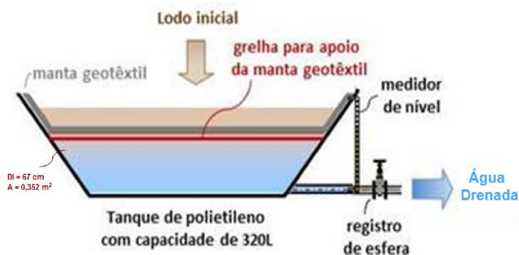
Figura 19 - Esquema da unidade de desaguamento utilizada na escala piloto
