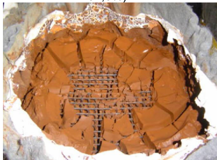
Figura 34 - Torta de lodo tipo A após 5 dias de secagem na condição controlada de inverno (ST 32,6%)
