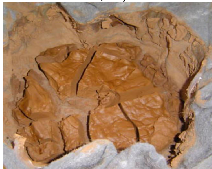
Figura 33 – Torta de lodo tipo B após 5 dias de secagem na condição controlada de verão (ST 23,5%)
