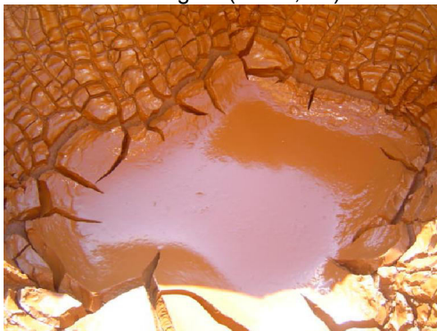
Figura 37 - Torta do lodo tipo A logo após a fase de drenagem (ST 12,9%)
