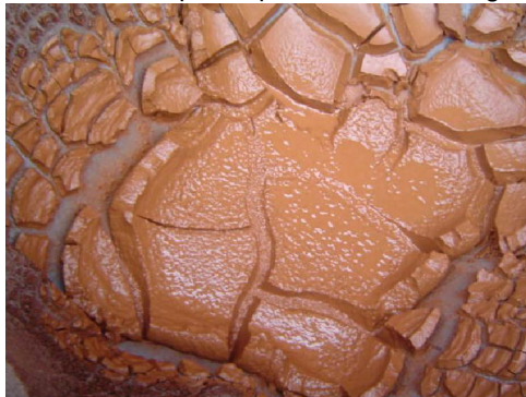
Figura 39 - Torta do lodo tipo A após 7 dias de secagem (ST 16,6%)
