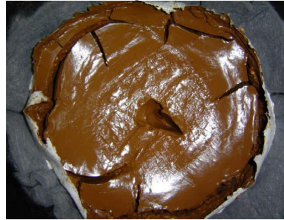
Figura 29 – Torta de lodo tipo B logo após a fase de drenagem (ST 13,9%)
