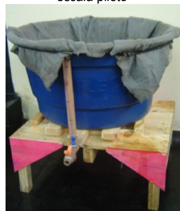
Figura 20 – Foto da unidade de desaguamento utilizada na escala piloto
