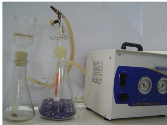
Figura 22– Foto dos equipamentos utilizados no teste de resistência específica
