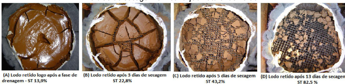
Figura 31 – Fotos da torta de lodo tipo B retida na manta logo após a fase de drenagem e após 3, 5 e 13 dias de secagem em condição natural de verão
