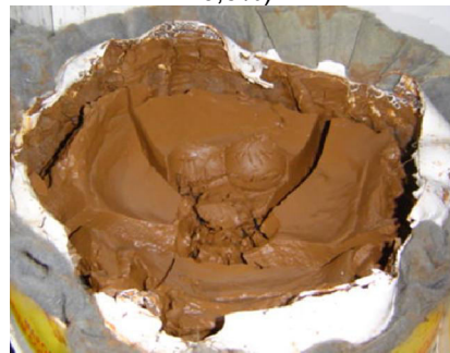
Figura 35 -Torta de lodo tipo B após 5 dias de secagem na condição controlada de inverno (ST 20,3%)
