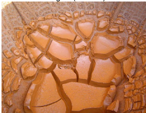
Figura 38 - Torta do lodo tipo A no 4º dia de secagem (ST 15%)
