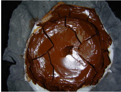
Figura 28 – Torta de lodo tipo A logo após a fase de drenagem (ST 15,7%)
