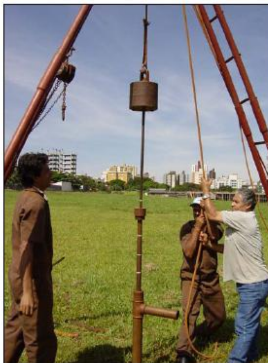
Figura 4 – Vista geral de uma equipe de sondagem de simples reconhecimento com ensaio SPT, Belincanta (2004).
