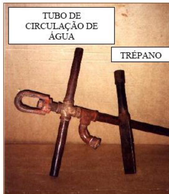
Figura 5 – Tubo de circulação de água e trépano de perfuração recomendados pela NBR 6.484/2001, modificado de Belincanta (2004).
