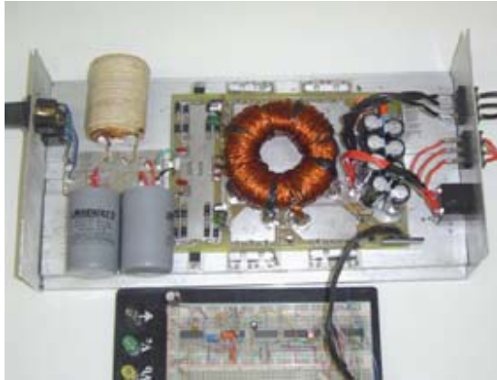
Figura 60 – Protótipo do inversor
