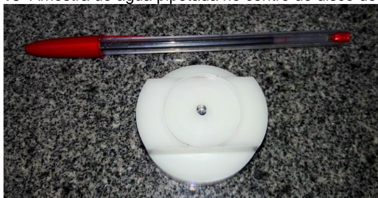
Figura 18 —Amostra de água pipetada no centro do disco de acrílico.
