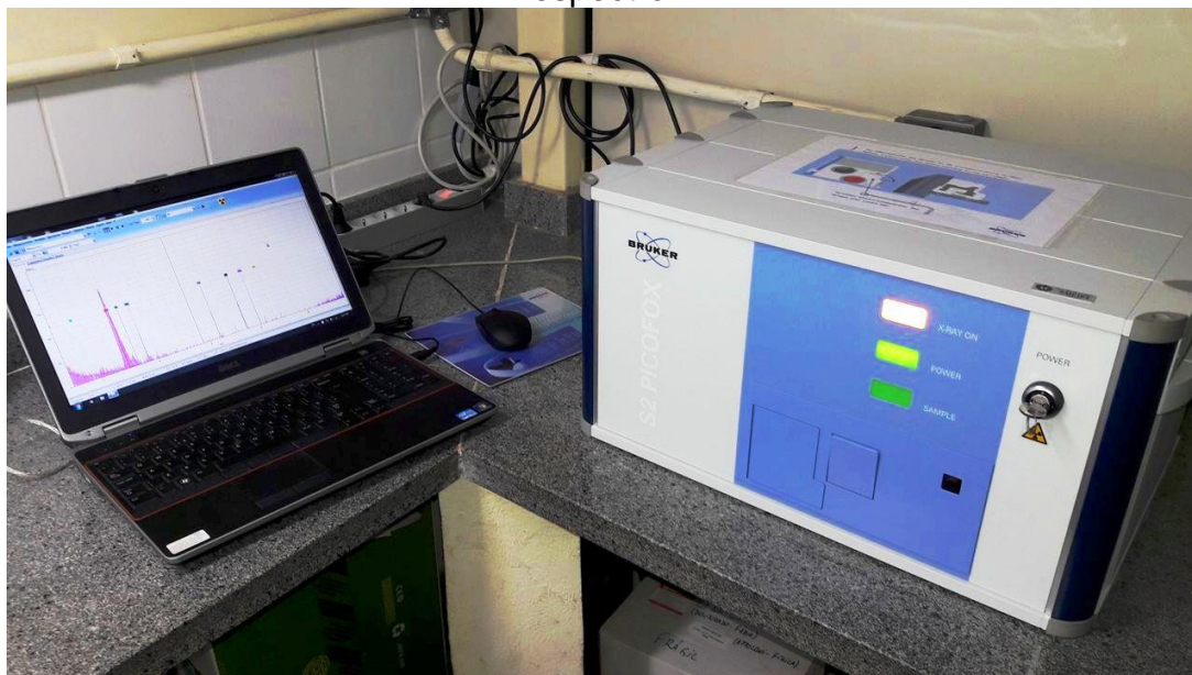
Figura 28 - Equipamento utilizado S2 Picofox da Bruker e notebook para análise do espectro.
