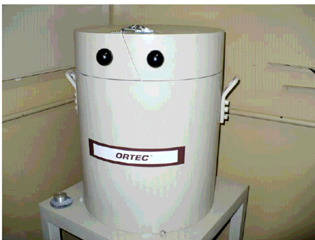
Figura 5 – Blindagem da ORTEC modelo HPLBS1.
