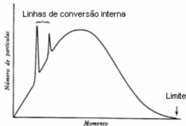
Figura 2 – Representação esquemática da distribuição do momento das partículas beta emitidas por uma fonte radioativa adaptada de Appoloni, (2006).
