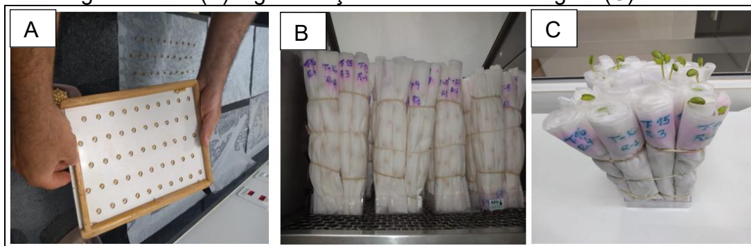
Figura 11 - Teste de germinação: contador de sementes (A), acondicionamento no germinador (B) e germinação no dia da 1ª contagem (C).
