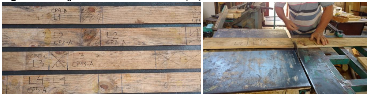
Figura 56 - Regiões com nós e defeitos e peças sendo cortadas
