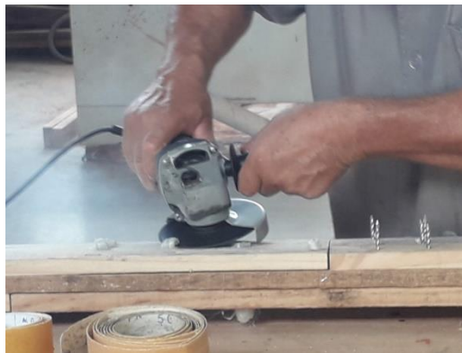
Figura 65 - Excessos sendo cortados
