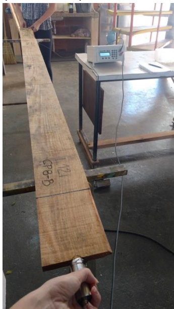
Figura 52 - Classificação mecânica dinâmica (ultrassom)
