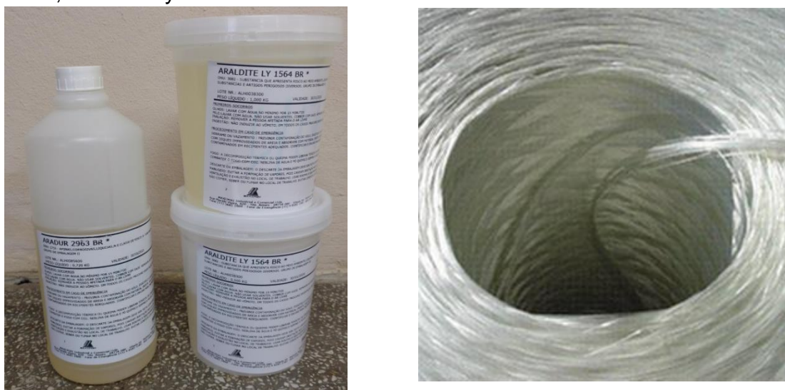
Figura 18 - Materiais utilizados na mistura do compósito estrutural: Aradur 2963, Araldite Ly 1564BR e fibra de vidro Advantex E-CR GLASS
