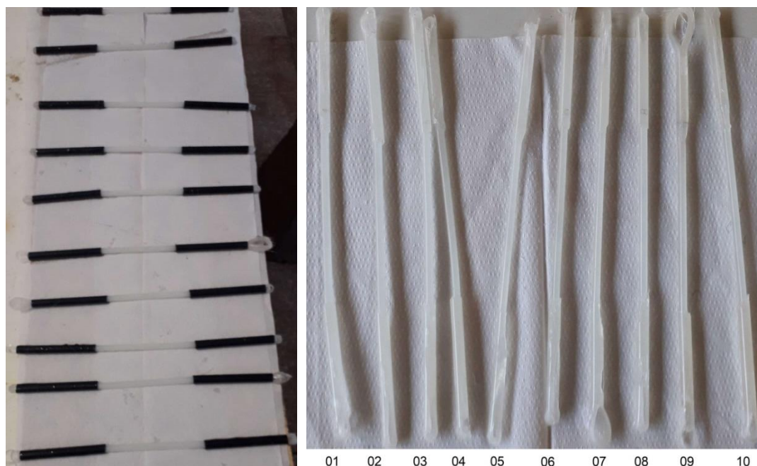
Figura 31 - Fabricação dos corpos de Prova e Corpos de prova desenformados
