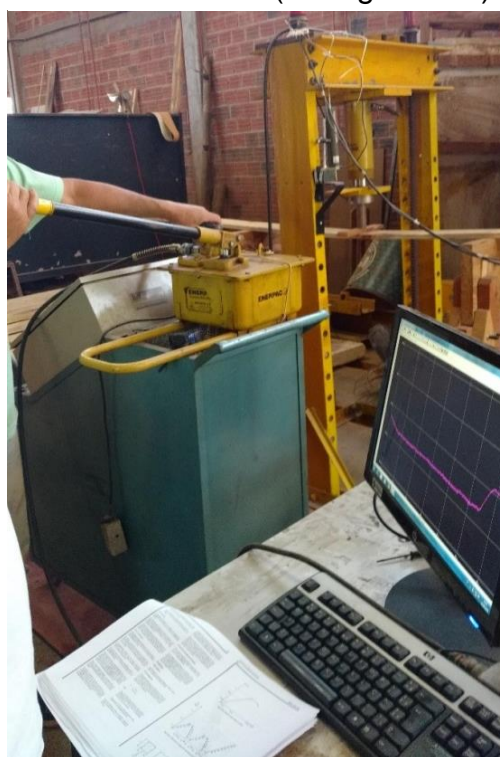
Figura 50 - Classificação mecânica estática (carregamento)
