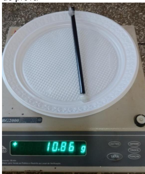
Figura 24 - Pesagem dos corpos de prova
