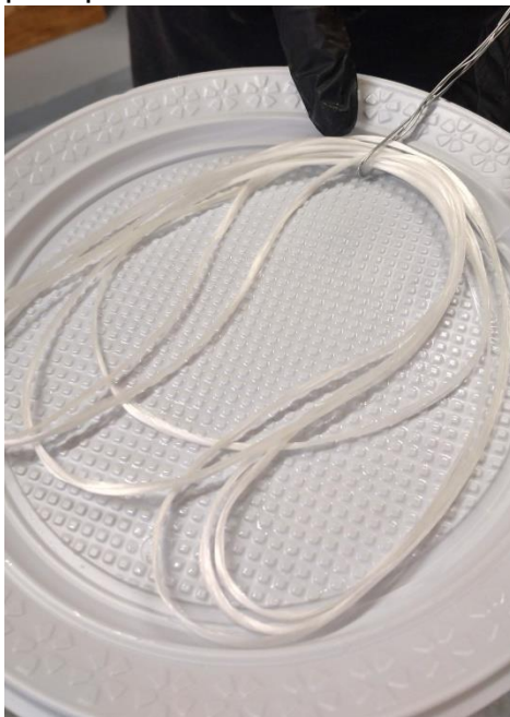
Figura 23 - Banho das fibras na resina e fio metálico utilizado para passá-las no canudo
