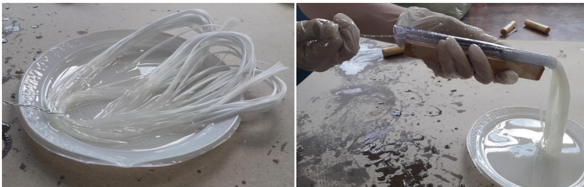
Figura 61 - Banho de resina e fibras posicionadas no molde
