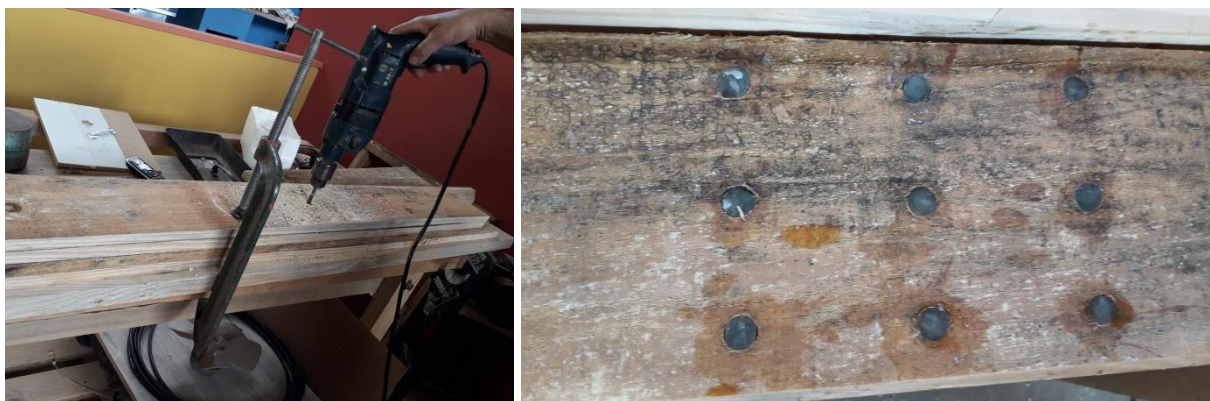
Figura 63 - Furação com auxílio de gabarito e cavilhas inseridas no corpo de prova
