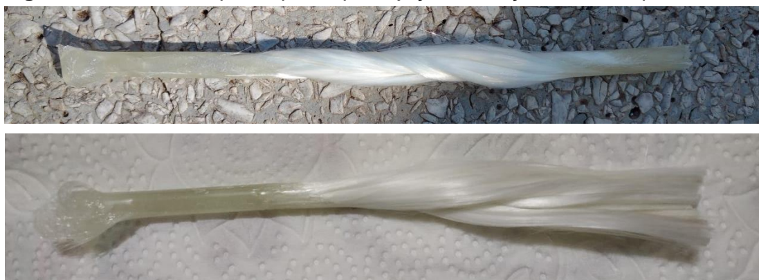
Figura 21 - Acima corpo de prova por injeção e sucção e abaixo por infusão
