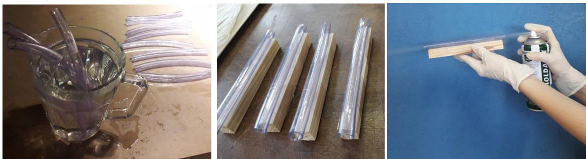
Figura 60 - Molde imerso em água quente, moldes aderidos à peça de madeira e aplicação de desmoldante
