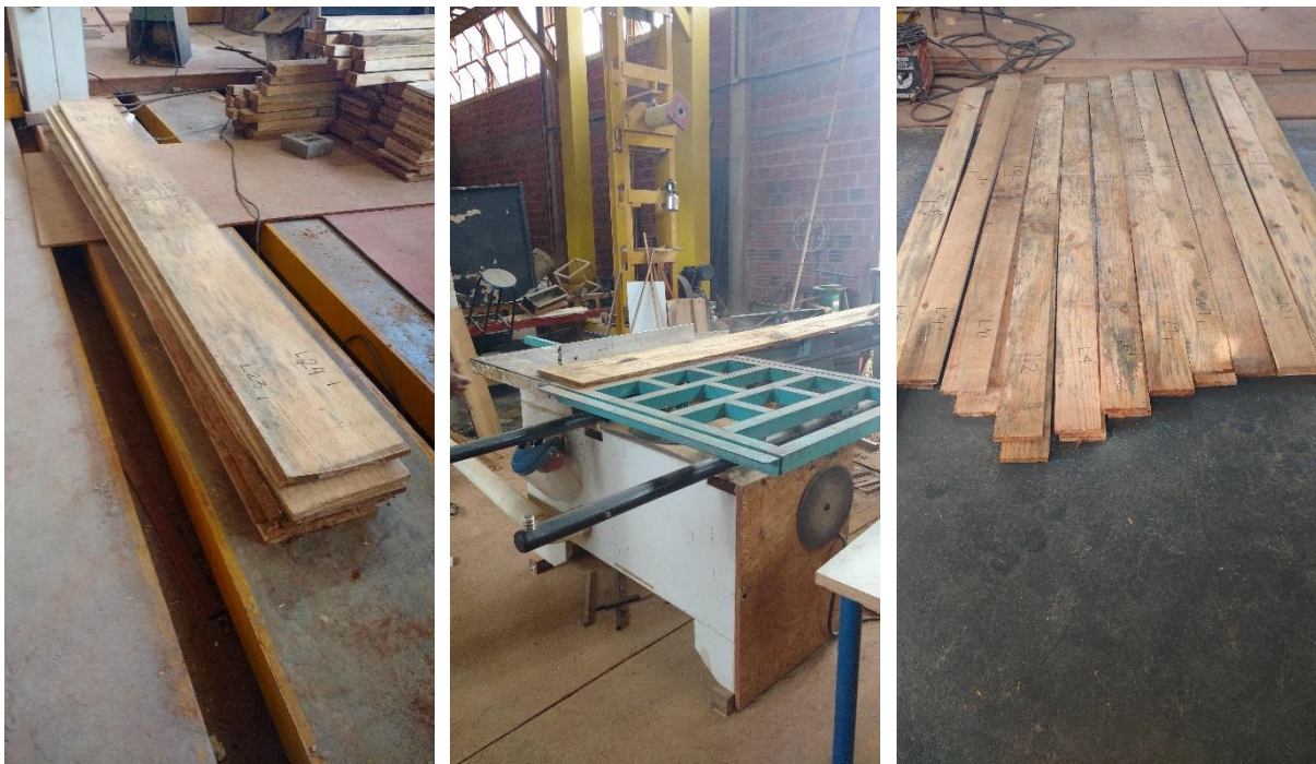
Figura 49 - Tábuas 30 cm de largura, perfilamento das tábuas e tábuas 14 cm largura
