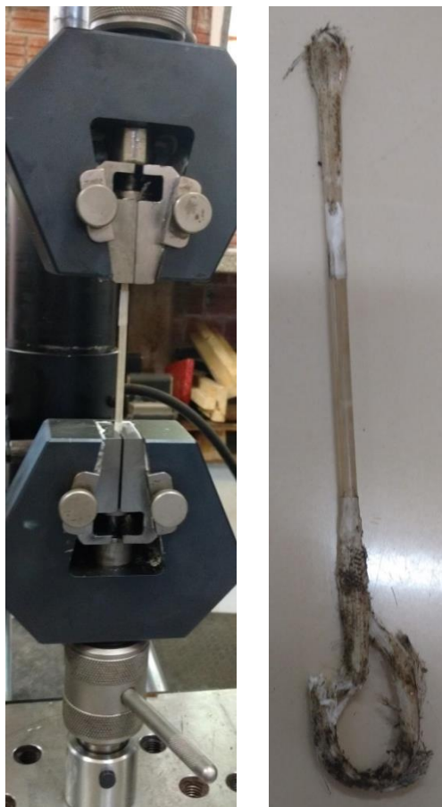
Figura 29 - Ensaio corpo de prova Ø 4 mm
