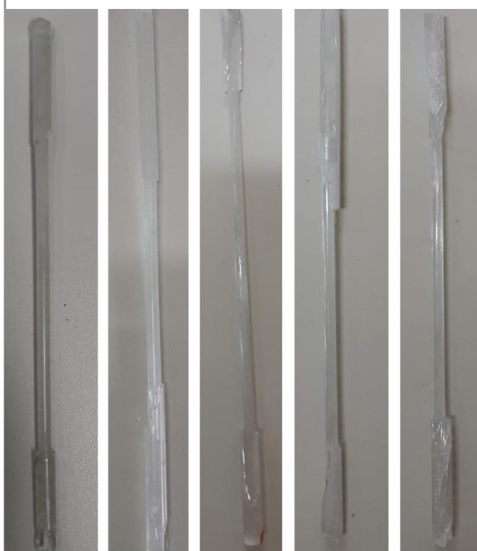
Figura 30 - Corpos de prova com diferentes diâmetros centrais
