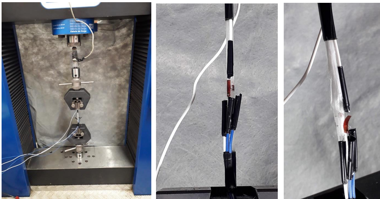
Figura 46 - Da esquerda para a direita: Corpo de prova na EMIC DL 30000 com fios ligados ao sistema de aquisição de dados Lynx AqDados 7.2, corpo de prova antes da ruptura e corpo de prova após ruptura.
