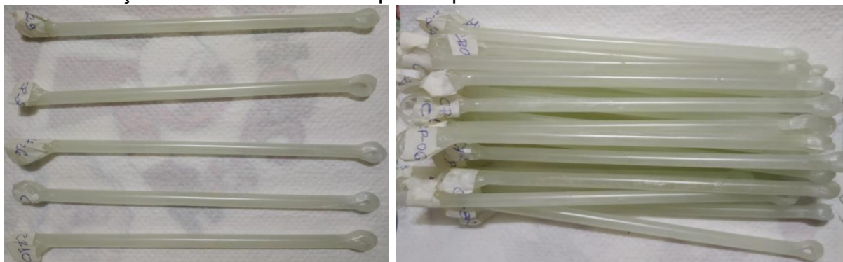
Figura 27 - Corpos de prova desmoldados: à esquerda os selecionados para o ensaio à tração e à direita demais corpos de prova
