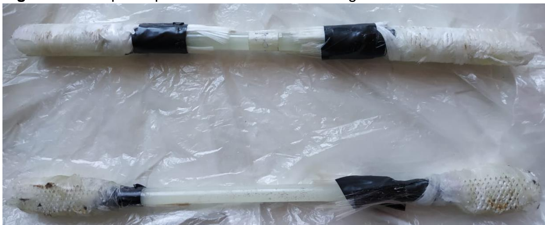
Figura 28 - Corpo de prova com extremidades engrossadas
