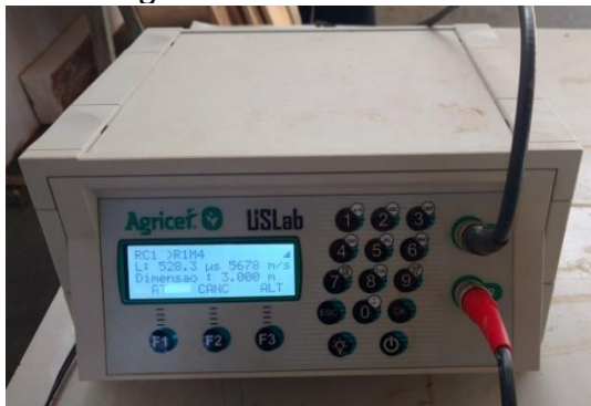
Figura 51 - Ultrassom USLab da marca Agricef
