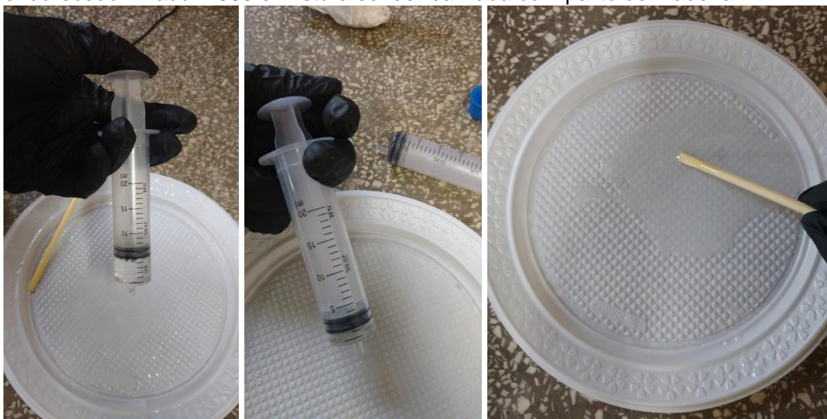
Figura 22 - Preparação da mistura: Inserção da resina epóxi Araldite Ly 1564BR, do endurecedor Aradur 2963 e mistura sendo realizada com palito de madeira
