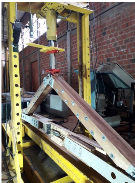
Figura 67 - Imagem do pórtico metálico com corpo de prova montado no aparato utilizando-se medidores LVDT
