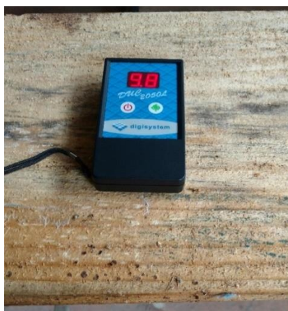
Figura 48 - Medição da umidade da madeira
