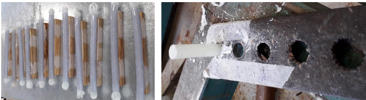
Figura 62 - Cavilhas pré-fabricadas e cavilhas com 6 cm de comprimento sendo retificadas
