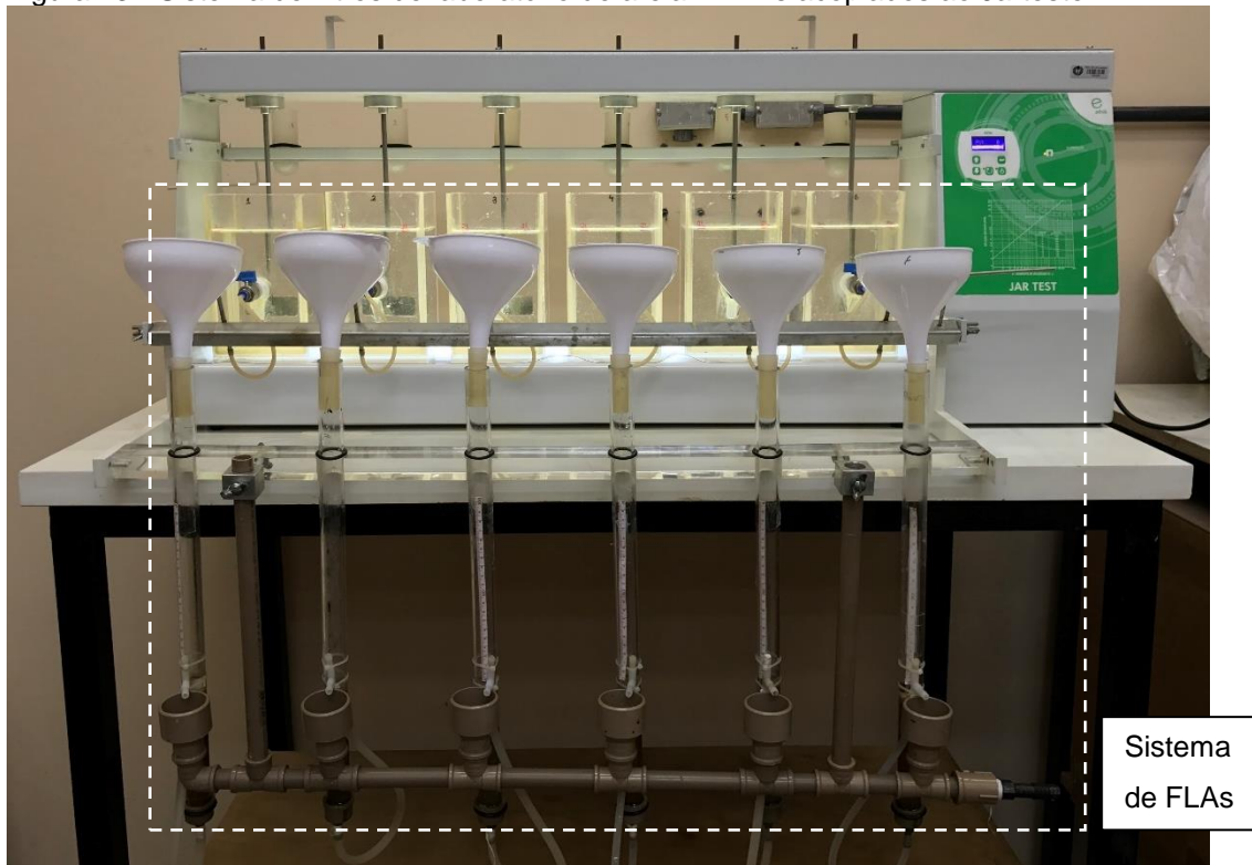
Figura 13 - Sistema de filtros de laboratório de areia – FLAs acoplados ao Jarteste
