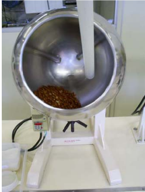
Figura 4 – Drageadeira Siaht de 10 litros
