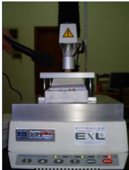
Figura 8 – Amostra de amendoim crocante durante análise no Texturômetro TA XT Plus - Extralab Brasil
