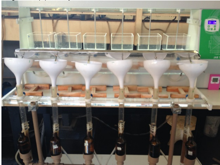
Figura 6 - Equipamento jarteste e sistema de filtros de laboratório de areia – FLAs
