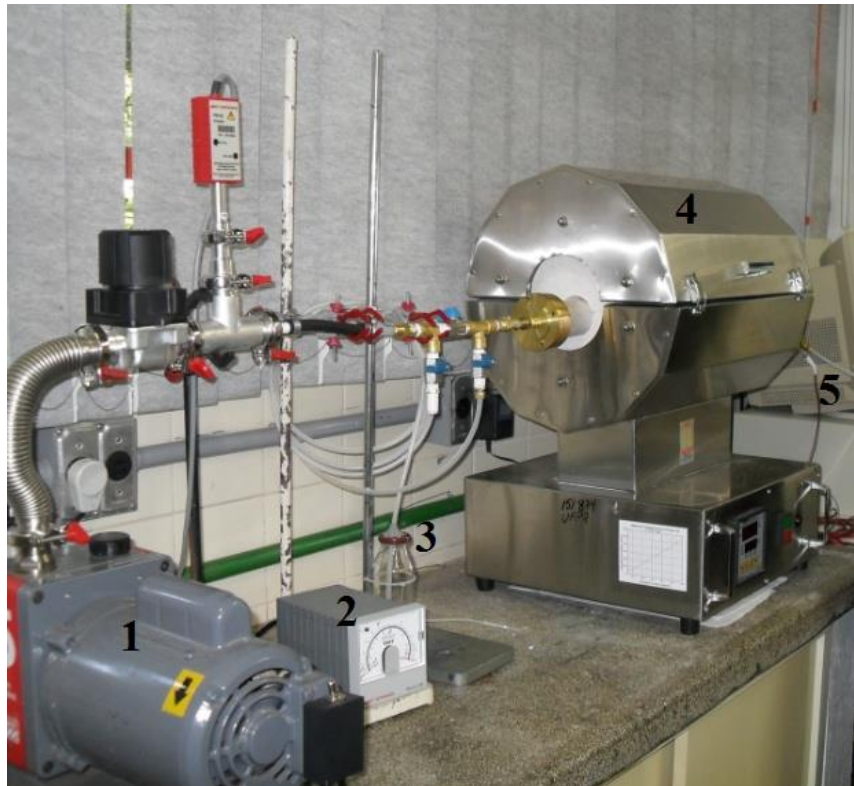
Figura 4.1 – Montagem experimental para o tratamento térmico, onde (1) bomba de vácuo mecânica, (2) medidor de vácuo, (3) controlador de fluxo de gás, (4) forno, (5) fio do termopar.
