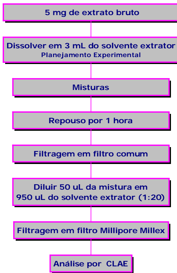
Figura 10: Seqüência do procedimento para o preparo das amostras para análise por Cromatografia Líquida de Alta Eficiência.
