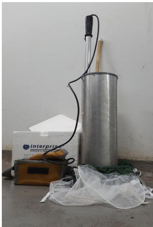
Figura 5 – Aspirador de Nasci modificado, ferramenta utilizada para a captura de mosquitos adultos.
