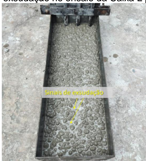
Figura 98 - Presença de exsudação no ensaio da Caixa L para o concreto CLAA24h
