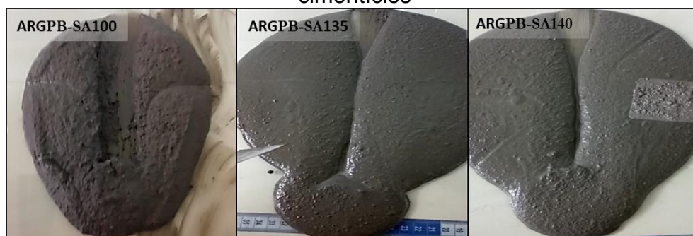
Figura 88 - Trisco das argamassas com combinação ternária de materiais cimentícios
