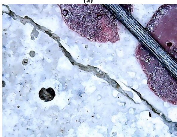
Figura 131 – Condição de cura submersa: Imagens da fissura para o cp S9_5#18 aos (a) 28 (b) 112 e (c) 196 dias
