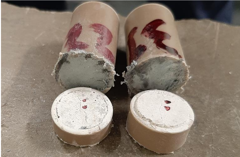
Figura 33 – Corpos de prova 40 mm x 20 mm e amostras (altura de 5,0 mm aproximadamente) extraídas para MEV
