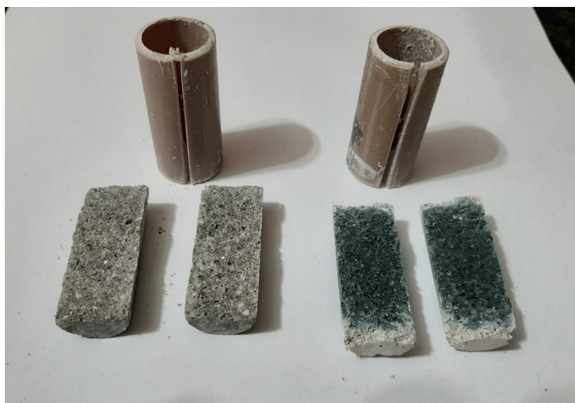
Figura 57 – Corpos de prova no molde de PVC para água fria soldável de 20 mm (17 mm interno) rompidos por compressão diametral pelo torno de bancada N°5
