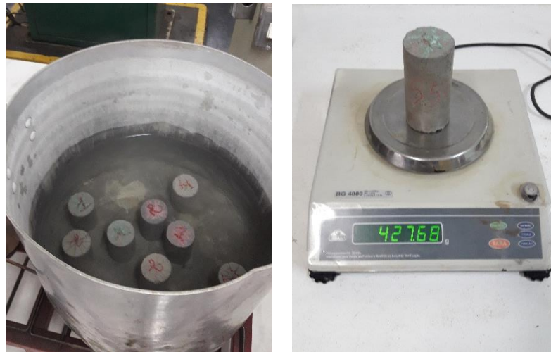
Figura 20 – Detalhes ensaio de absorção: (a) fervura e (b) corpo de prova em balança
