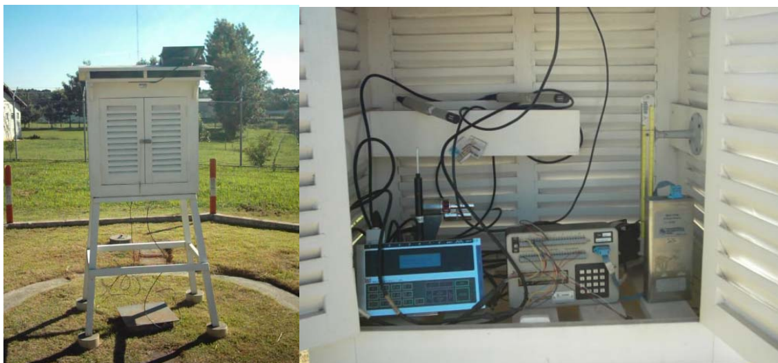
Figura 19 - Disposição dos equipamentos utilizados para a realização da calibração
