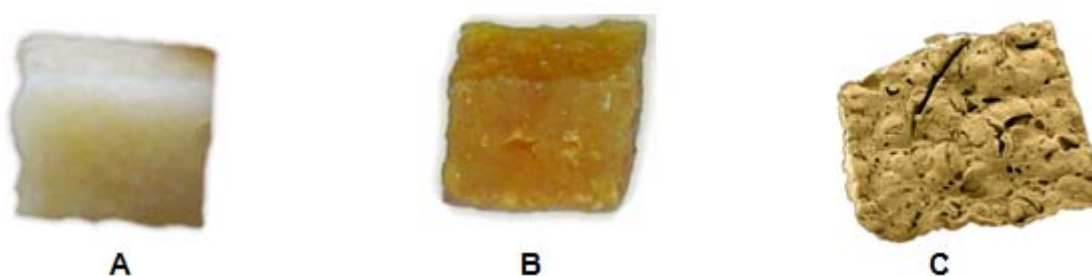
Figura 10 – Esferas de Saccharomyces cerevisiae obtidas pelo método de imobilização em cubos de ágar-ágar, sendo “A” a esfera úmida, “B” a esfera seca em estufa a 45^\circ\text{C} e “C” a esfera observada em microscopia eletrônica de varredura com um aumento de 50 vezes.
