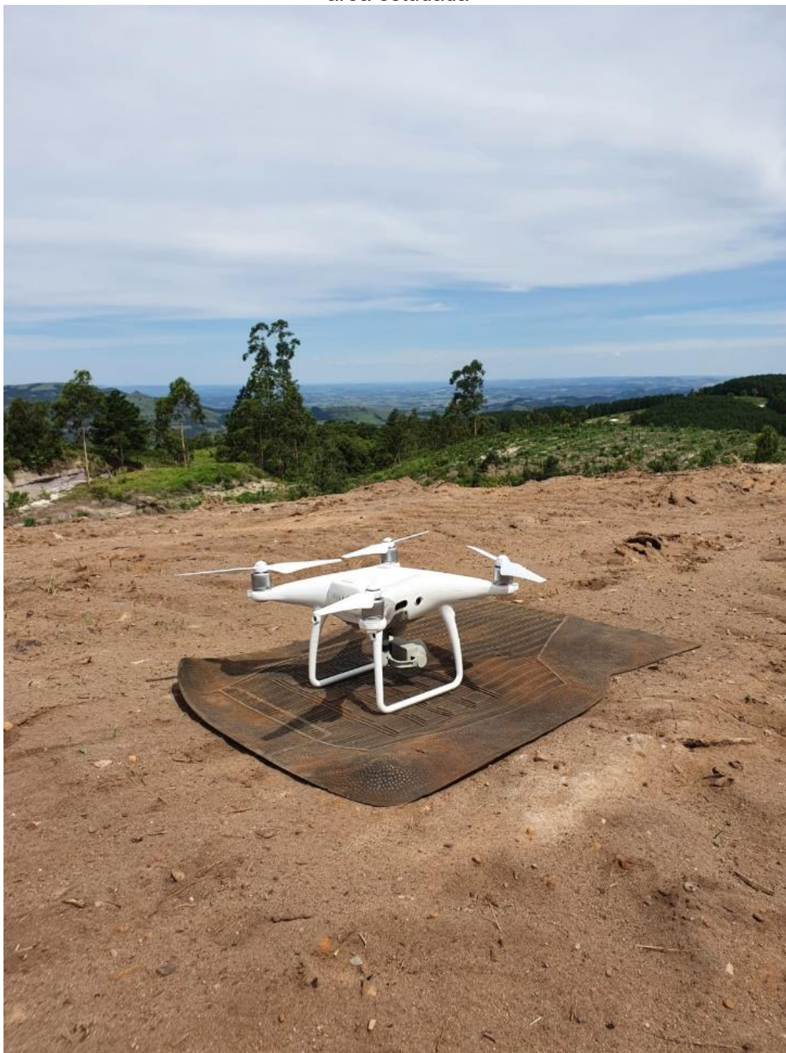
Figura 17: Drone Phantom 4 Pro utilizado para a captação de imagens aéreas da área estudada
